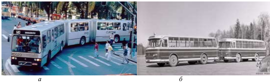
Рис. 1. Триланковий напівпричпний (а) и дволанковий причпний (б) автопоїзд
