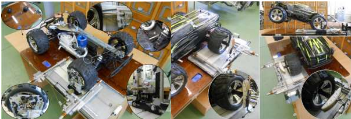
Рис. 1. До визначення характеристик еластичного колеса та параметрів його взаємодії з опорною поверхнею
