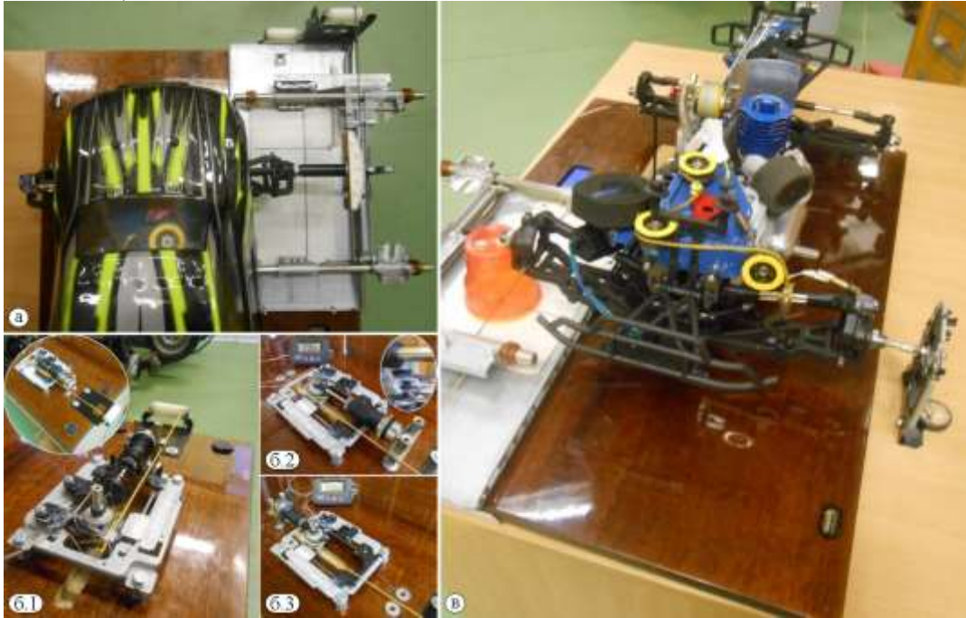
Рис. 2. До визначення параметрів системи рульового керування (а) фізичної моделі автомобіля, пружного (б.1) та демпферного (б.2, б.3) пристроїв його підвісок, а також стабілізаторів поперечної стійкості (в)
