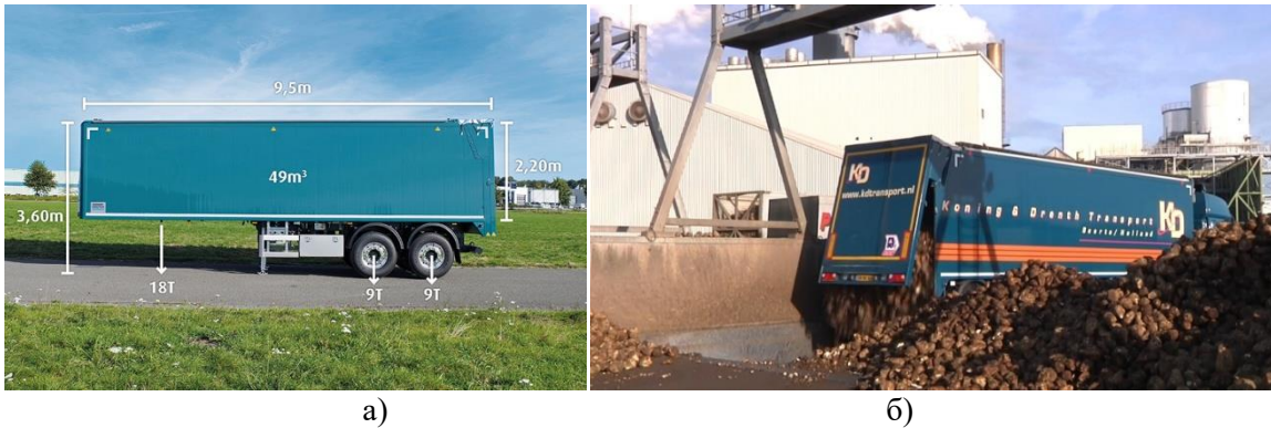
Рисунок 2 – Напівпричіп Knarpen Trailers для перевезення цукрового буряка: а – зовнішній вигляд причепа, б – процес розвантаження
