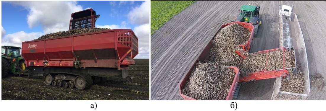
Рисунок 1 – Використання причепа перенавантажувача Amity T32 при збиранні цукрового буряка: а - причіп Amity T32, б – процес перенавантаження
