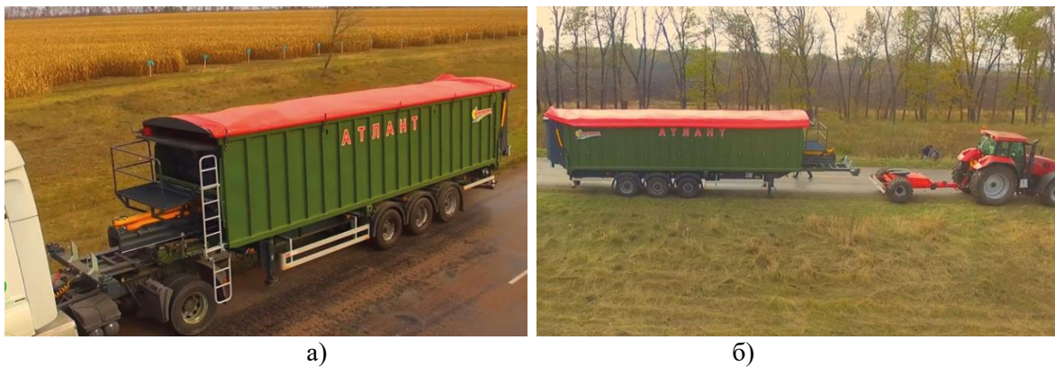
Рисунок 3 – Напівпричіп АЗП-46: а – в складі автопоїзда, б – агрегування з трактором
