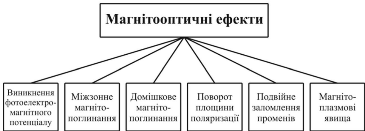
Рисунок 12.4. Основні магнітооптичні ефекти
