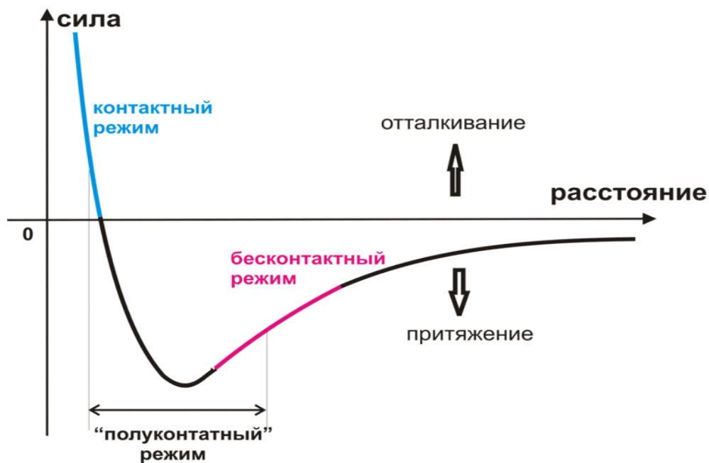
Рисунок 1.3 – Графік залежності сили Ван-дер-Ваальса від відстані між кантилевером і поверхнею зразка
