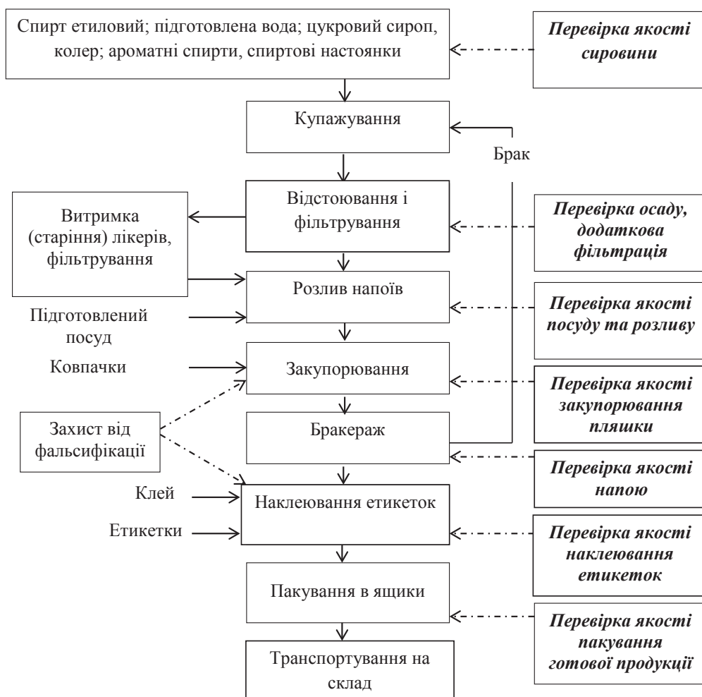
Рис. 1. Технологічний цикл виробництва лікєро-горілкової продукції
