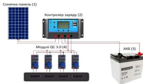
Рис.1.Спрощена схема автономної електростанції
