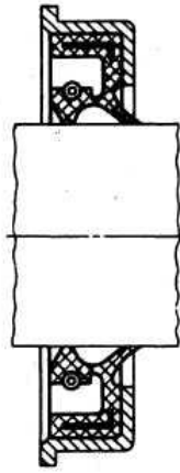
Рис. 6.179 – Севанитове ущільнення валу з еластомірною манжетною
