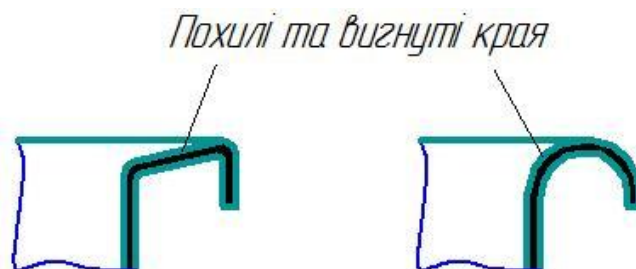
Рис. 6.50 – Гігієнічні конструкції обводів
