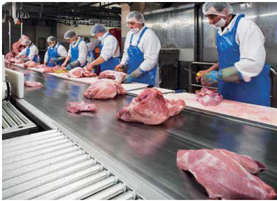
Рис. 6.65 – Конвеєр з металевою транспортною стрічкою:
