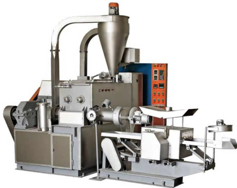
Рис. 6.7 – Зовнішній вигляд макаронного пресу виробництва ПКП БИД (м. Дніпро)
