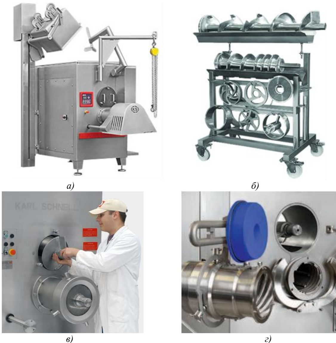
Рис. 6.81 – Технічні рішення, які підвищують зручність обслуговування вовчків: а) таль для установки робочого шнека; б) візок для перевезення різального інструменту, робочого і подавального шнеків; в) розташування подавального шнека над робочим шнеком; г) відкидна горловина робочого циліндра
