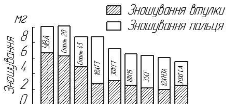
Рис. 7.23 – Зношування пальців і втулок, виготовлених із різних сталей
