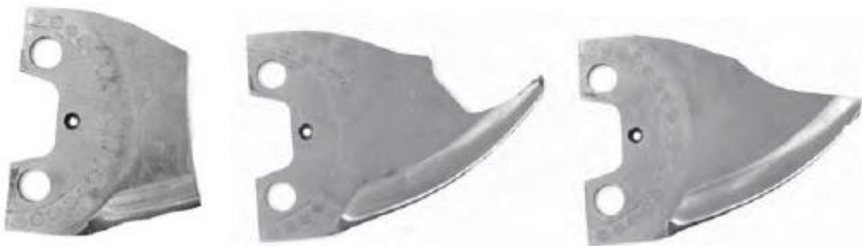
Рис. 7.27 – Приклади зруйнованих ножів кутера
