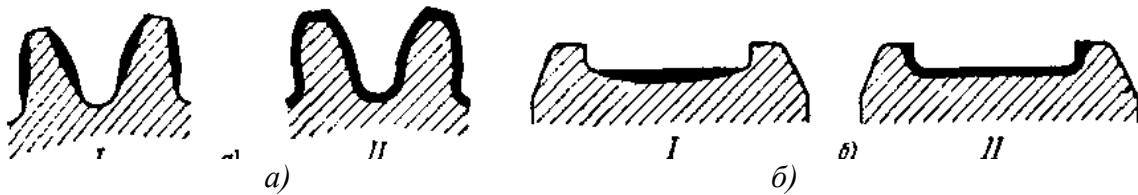
Рис. 7.39 – Схеми поверхневого загартування (II – правильна, I – неправильна): а) зубців шестерні; б) шийки колінчастого валу
