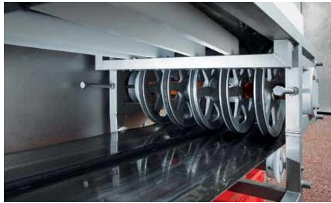
Рис. 6.65 – Конвеєр з металевою транспортною стрічкою:
