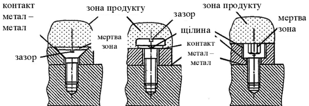
Рис. 6.33 – Ризики, створені негігієнічним використанням гвинтів
