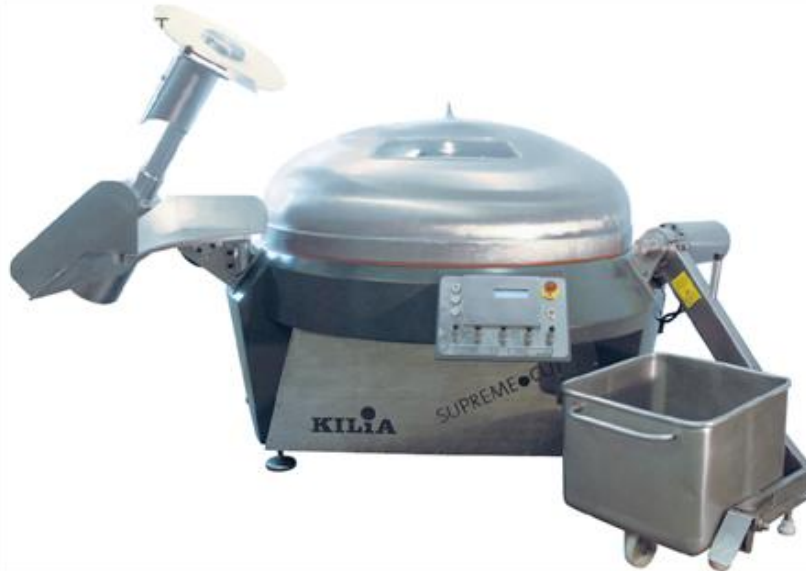
Рис. 6.84 – Конструкція кутера, що забезпечує малу шумову емісію
