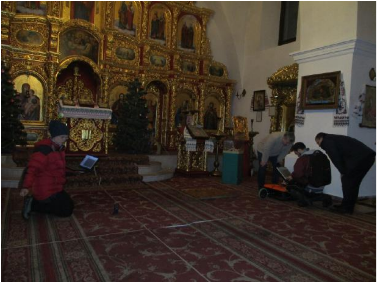
Георадарні вимірювання у храмі. Лютий 2019. Світлина Н. Кукси
