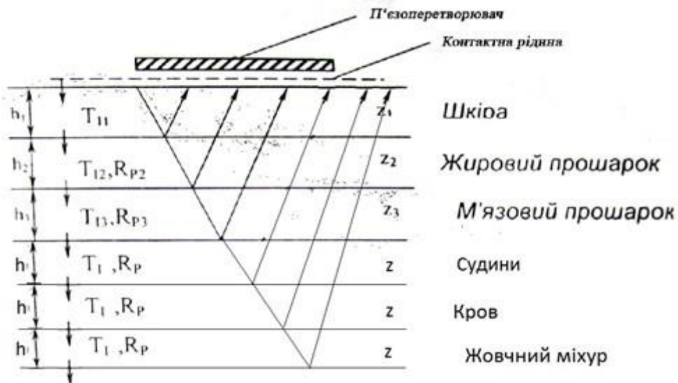
Еквівалентна схема проходження ультразвуку через біологічні шари при дослідженні жовчного міхура
