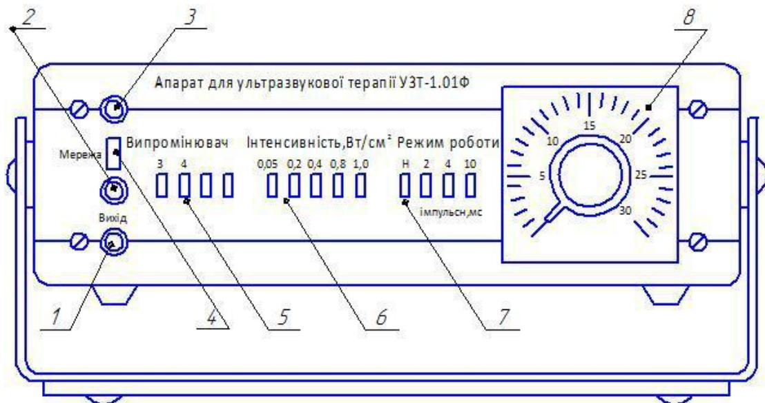
Рисунок 2.21 – Загальний вигляд УЗТ-1.01.Ф: 1 – роз’єм «ВИХІД» для підключення кабелю випромінювача; 2 – світловий індикатор вихідної напруги апарату; 3 – світловий індикатор «МЕРЕЖА» включення апарату; 4 – кнопка «МЕРЕЖА»; 5 – перемикач «випромінювач»; 6 – перемикач «інтенсивності, Вт/см 2 »; 7 – перемикач «РЕЖИМ РОБОТИ»; 8 – процедурний годинник, за допомогою якого відбувається вмикання апарату в мережу
