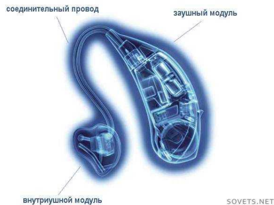
Рисунок 2.42 – Будова слухового апарату
