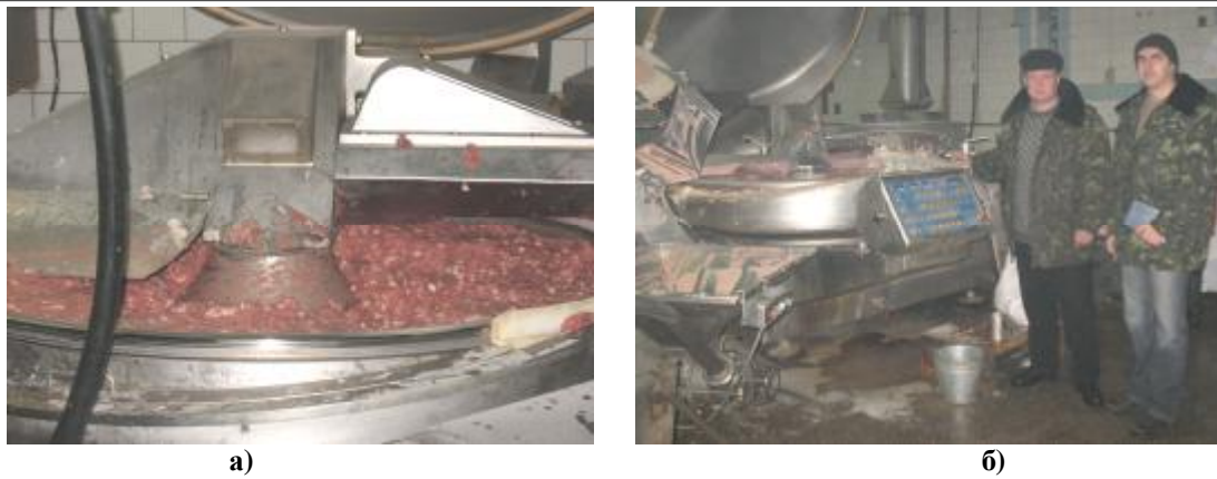
Рис. 2. Експериментальне визначення параметрів продуктивності кутерів: а – чаша кутера Laska KR-200-2V із обробленої сировини; б – визначення тривалості окремих операцій при роботі кутера Laska KR-330-2V
