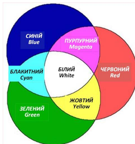
Рисунок 6.1 Адитивний синтез кольору із застосуванням трьох основних випромінювань: червоного, зеленого та синього
