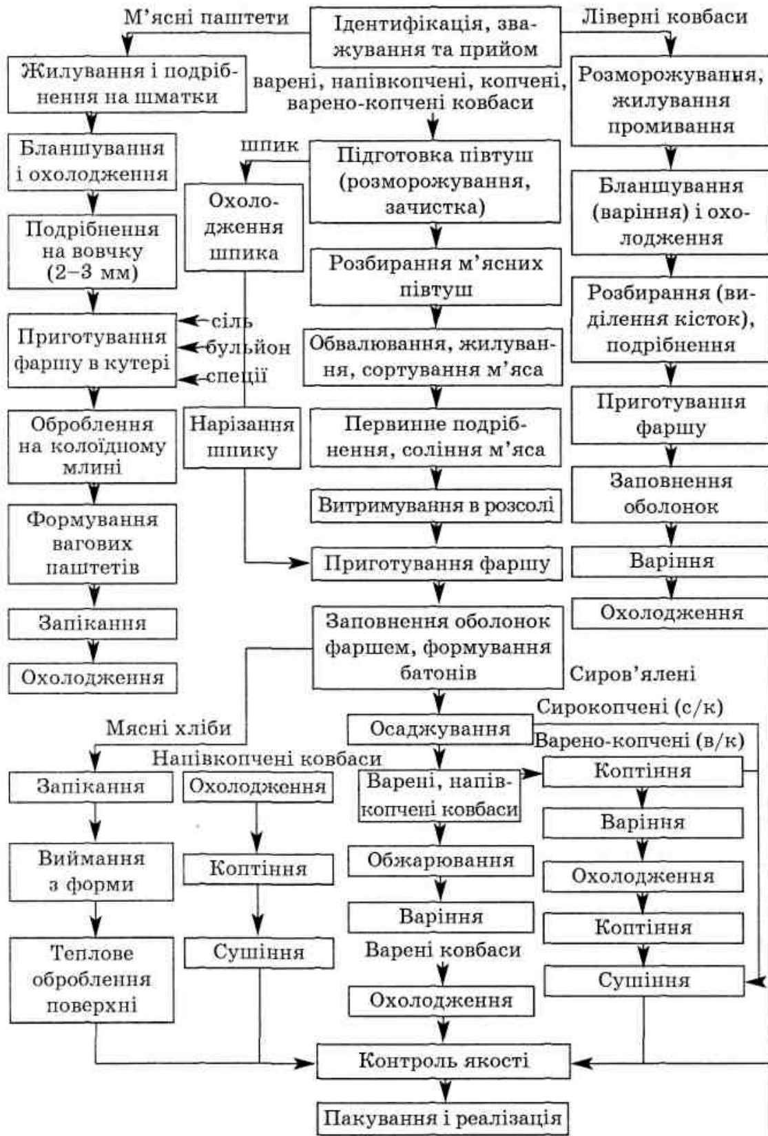
Рис. А.1 – Принципова технологічна схема виготовлення ковбасних і м'ясомістких виробів
