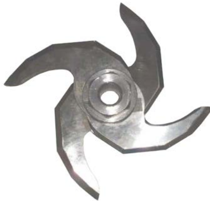
Рис. 6.3 – Ножі з ламаною різальною крайкою у вигляді логарифмічної спіралі
