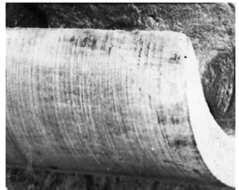
Рис. 14.6. Зношена поверхня підшипника підп'ятника каменевловлювача
