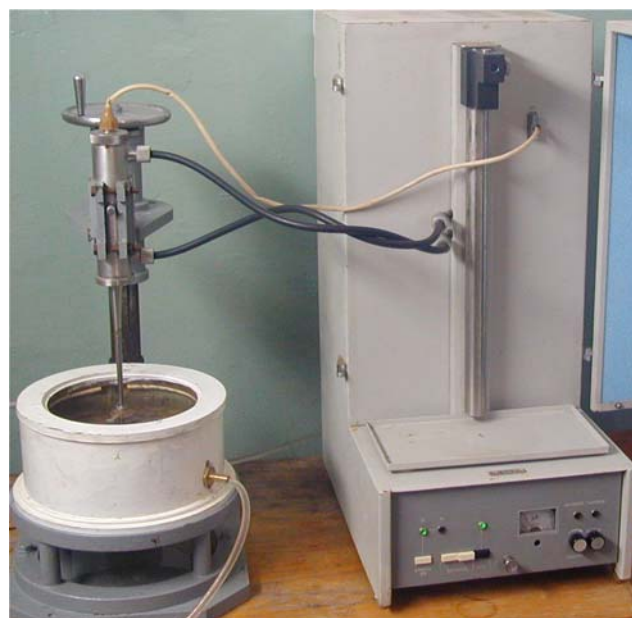
Рис. 14.15. Загальний вигляд (а) і схема (б) установки з магнітострикційним вібратором (МСВ): 1 – бак з водяною сорочкою; 2 – зразок; 3 – МСВ; 4 – вузол кріплення МСВ; 5 – гвинт; 6 – стояк; 7 – основа
