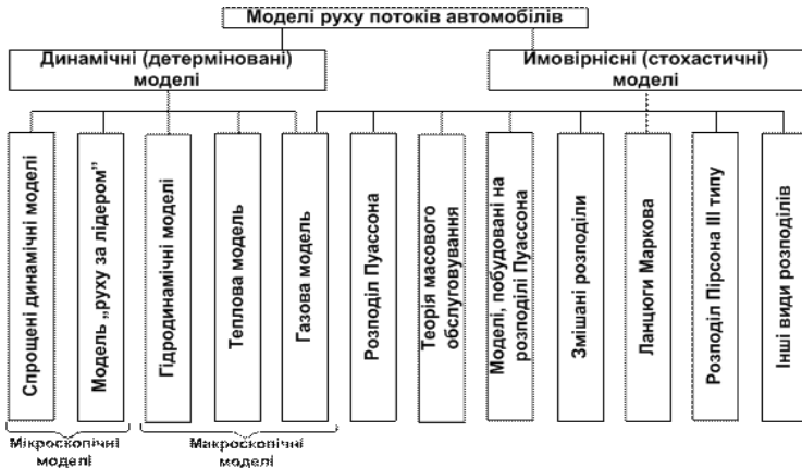
Рисунок 1 — Умовний поділ моделей транспортних потоків В моделі слідування за лідером рух транспортного засобу певним
