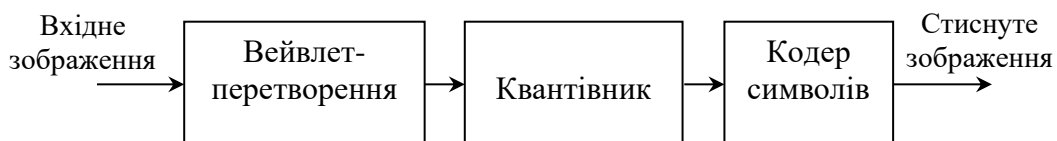
Рис. 8.6. Система вейвлет-кодування з втратами
