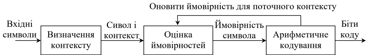
Рис. 7.5. Система адаптивного контекстно-залежного арифметичного кодування
