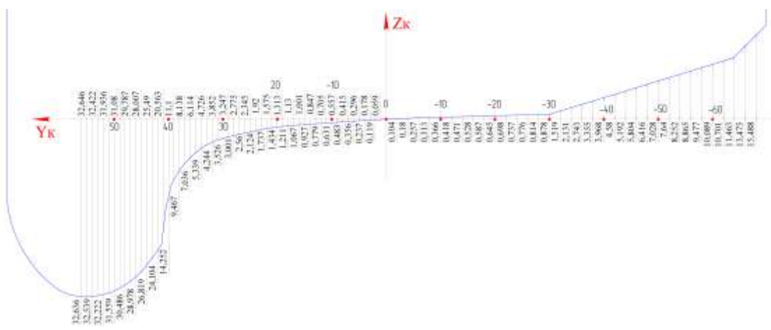
Рисунок 5. Геометрія зношеного профілю
