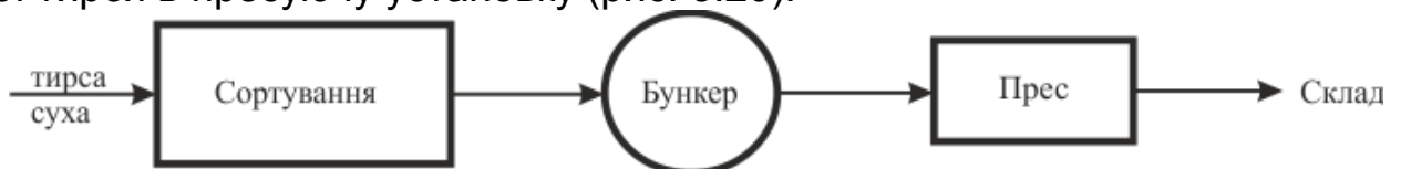
Рис. 3.20 – Технологічна схема виробництва брикетів із сухої тирси
