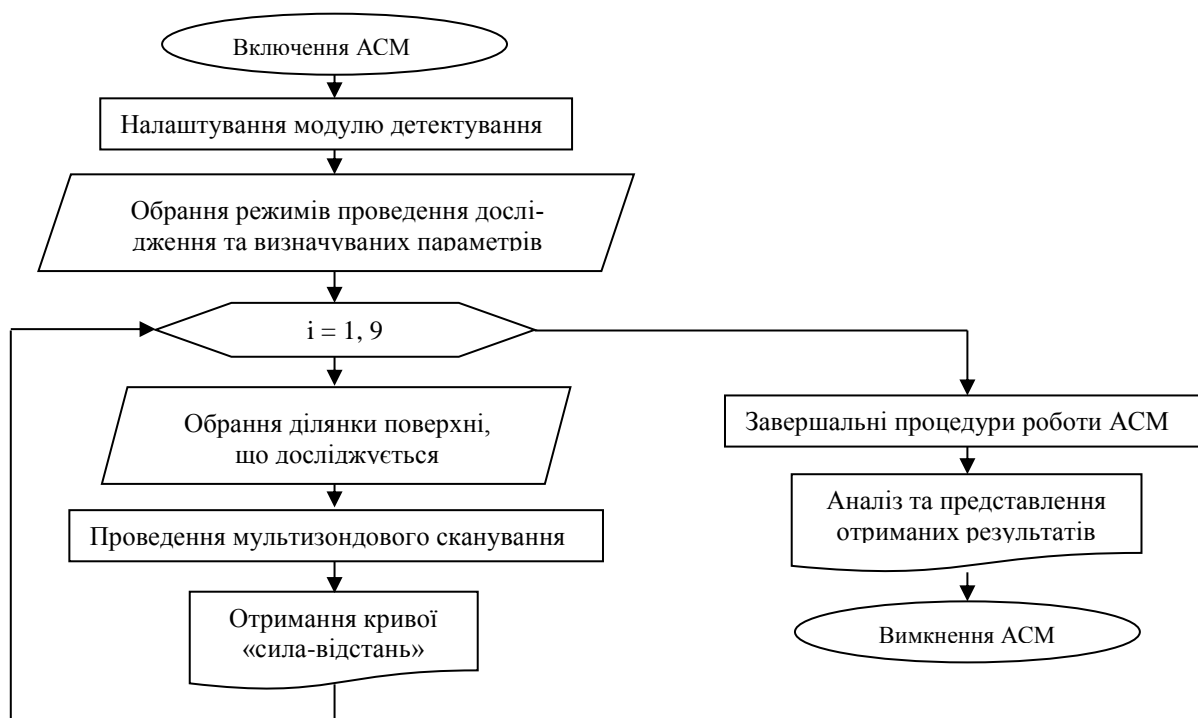
Рисунок 1 – Блок-схема дослідження функціональних поверхонь мехатронних пристроїв методом мультизондової атомно-силової мікроскопії
