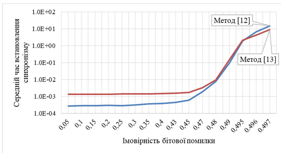
Рисунок 3 – Графіки залежностей середнього часу встановлення циклового синхронізму від ймовірності бітової помилки
