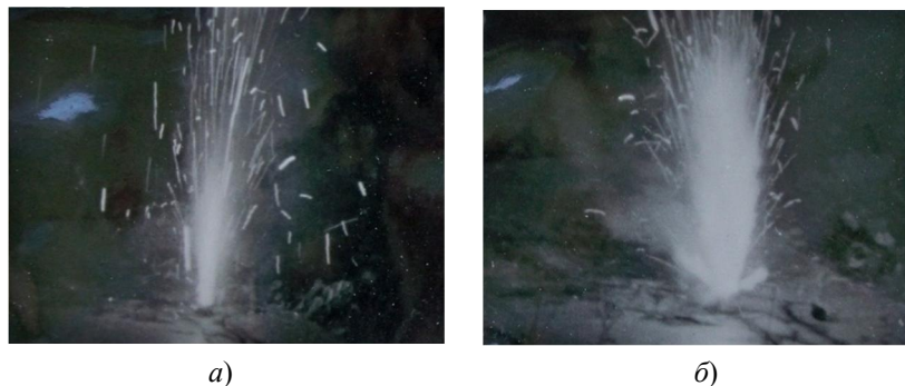
Рисунок 1 – Загальна картина процесу горіння двокомпонентних піротехнічних сумішей порошків магнію (а) та алюмінію (б) з оксидами металів (CuO, NiO та ін.) (суміші стехіометричні; T_0 = 300 \text{ K} ; P = 10^5 \text{ Па} ) [5, 6]
