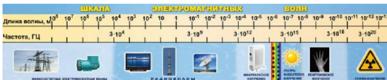
Рис. 46. Шкала электромагнитных волн.
