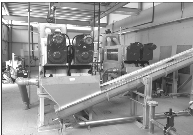
Рис. 1. Шнековый мультидисковый дегидратор MDQ (ОС, г. Озд, Венгрия)
