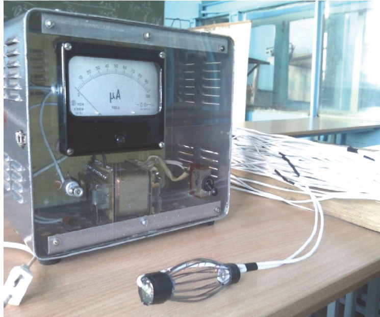
Рисунок 1. Прибор для обнаружения мест пескования скважин
