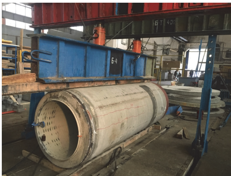
Рисунок 3. Испытание трубы трехлинейной нагрузкой
