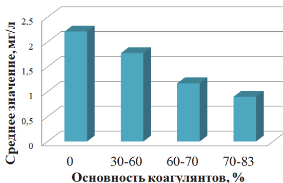
Рисунок 3. Содержание остаточного алюминия в пробах осветленной воды
