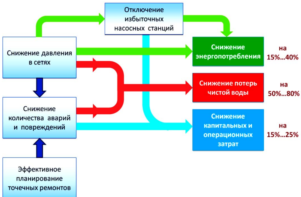
Рисунок 2. Направления снижения издержек водоканалов с помощью инструментов CityCom.
