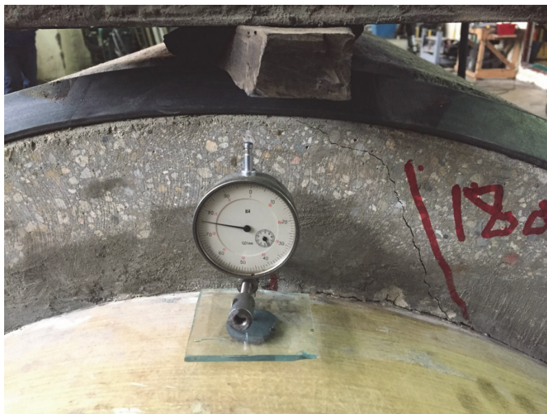
Рис.4. Внешний вид наклонной трещины в шельге
