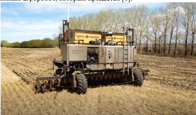
Рис. 1 - Автономная платформа Raven Autonomous Platform на посеве
