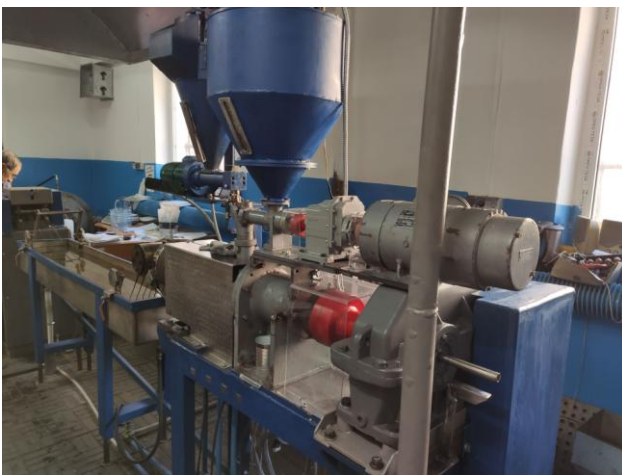
Рис. 3 - Двухкомпонентный опытный экструдер для получения полимерно-композиционных материалов.
