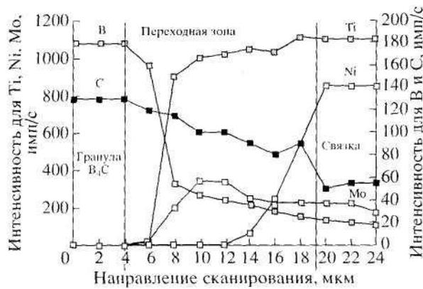
Рис. 6. Концентрационное распределение элементов в характеристическом рентгеновском излучении.
