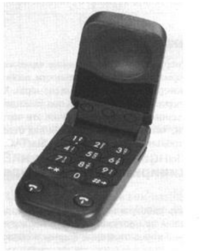
Рис. 9. Макет із пінопласту, що використовувався дизайнерами телефону StarTAC для дослідження альтернативних варіантів форми. 1990-і рр.
