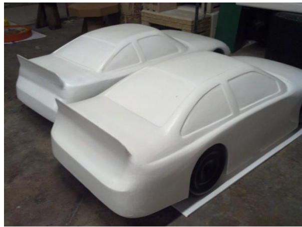
Рис. 11. Після вирізання із пінопласту загального профілю гоночного автомобіля (зліва), заготовки шліфуються та доводяться вручну до необхідного рівня деталізації (справа).
