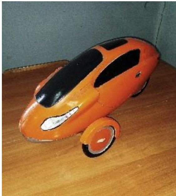
Рис. 18. Макет із піноплекса пофарбований аерозольною фарбою. Робота студентів кафедри дизайну ЧДТУ. 2000-ні рр.
