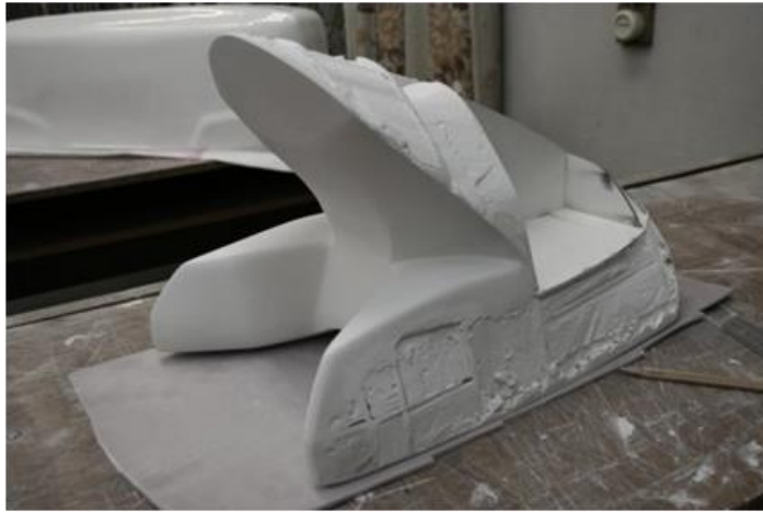
Рис. 23. Каркас заповнений піноплексом і зашкурений. Внутрішня сторона макета зашпакльована та зашкурена.
