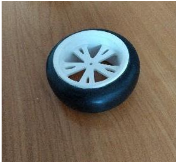
Рис. 21. Макет колеса виготовлений із піноплекса і пластика ПВХ
