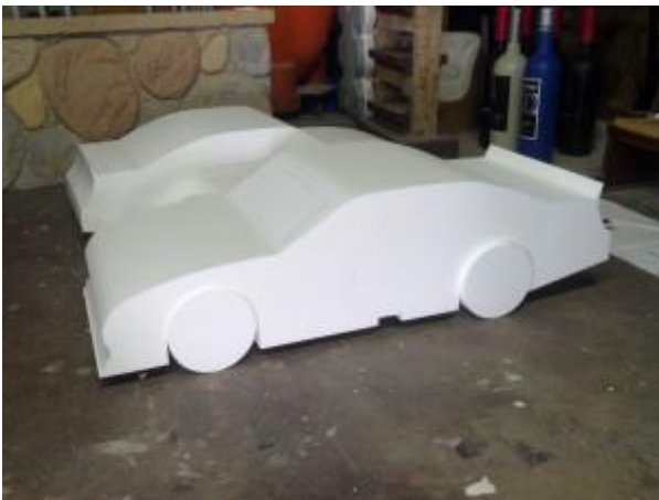
Рис. 11. Після вирізання із пінопласту загального профілю гоночного автомобіля (зліва), заготовки шліфуються та доводяться вручну до необхідного рівня деталізації (справа).
