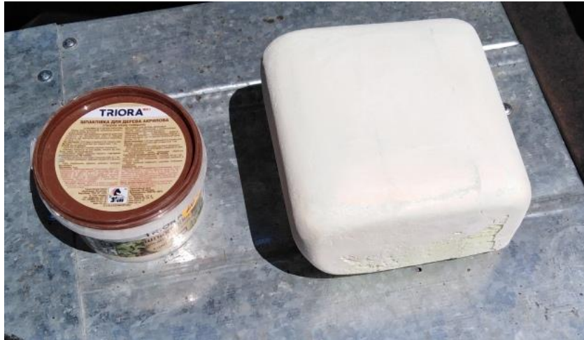
Рис. 16. Поверхня деталі після вирівнювання із допомогою шпаклівки
