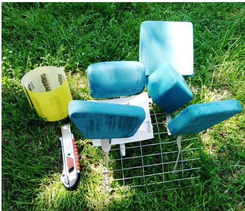
Рис. 18. Фарбування деталей макета водоемульсійною акриловою фарбою «SNIEZKA»
