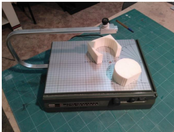
Рис. 15. Вирізання форми із заготовки
