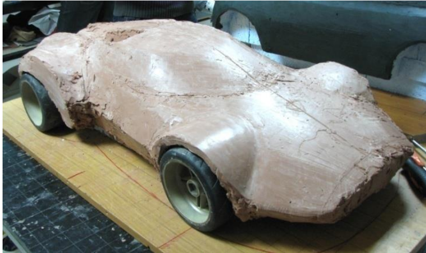
Рис. 5. Процес нанесення основного шару пластиліну на каркас. Чітко видно лінію поздовжньої симетрії для встановлення контрольного шаблону.
