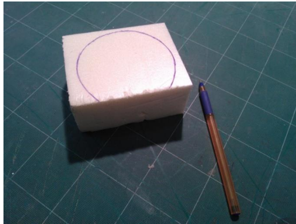
Рис. 14. На одній із площин заготовки нанесено контур деталі
