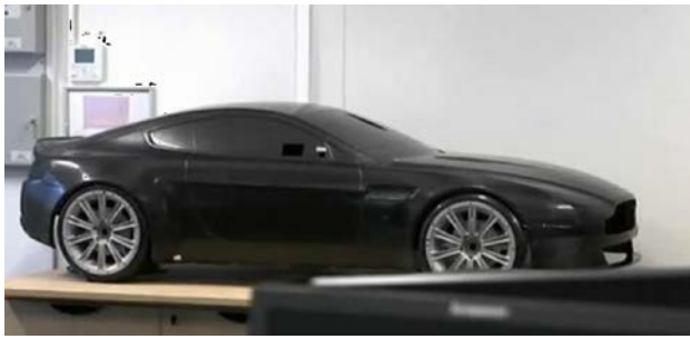
Рис. Б. 3. 28. Пластмасовий макет (а) та віртуальна модель (б) для з'ясування аеродинамічних характеристик форми Aston Martin. 2000-і рр.
