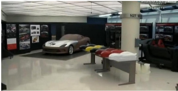
Рис. Б. 3. 16 а,б. Масштабні пошукові макети (передній план) та повномасштабний глиняний макет (задній план) Dodge SRT Viper (а); макет фрагменту інтер'єру (б). 2010-і рр.
