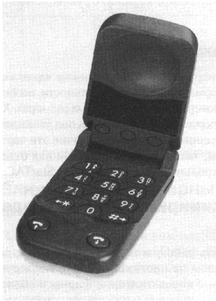
Рис. Б. 2. 11. М'яка (ліворуч) і жорстка (справа) моделі, що використовувалися дизайнерами телефону StarTAC для дослідження альтернативних варіантів форми. 1990-ті рр.
