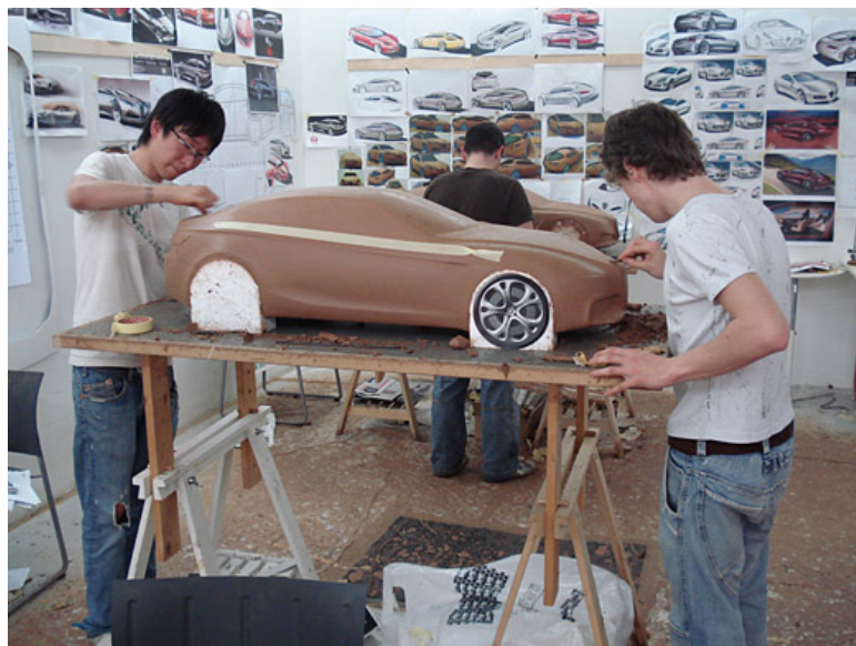
Рис. Б. 4. 8. Робота над макетом – накладання шару пластиліну та підготовка поверхні для фарбування. Політехнічна школа дизайну (Мілан). 2010-і рр.
