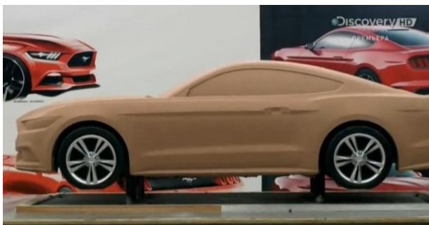
Рис. Б. 3. 8 а, б. Масштабні макети Mustang, виконані з різних матеріалів. 2010-і рр.
