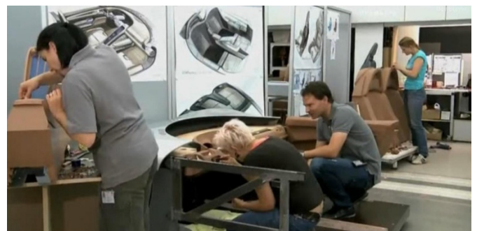
Рис. Б. 3. 34. Виконання масштабного макету Porsche 918 (а); виконання повномасштабного зіставного макету на станку з ЧПУ (б). 2010-і рр.
