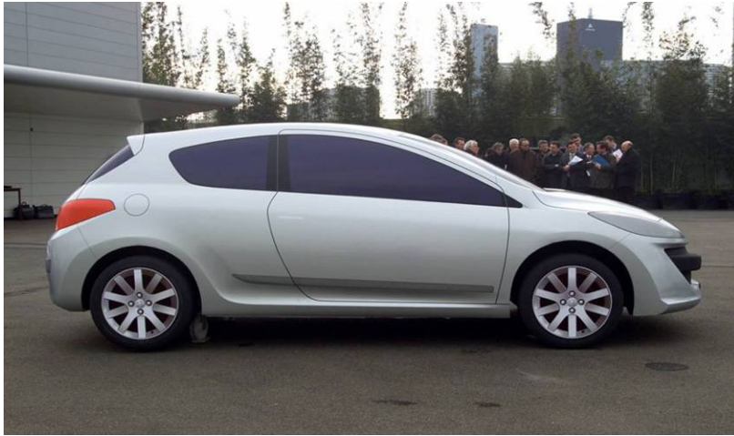
Рис. Б. 2. 42. Вікна, лінії дверей і фари макету виконані у вигляді наклейок, завдяки чому їх форму можна легко і швидко міняти. Середина 2000-х рр.
