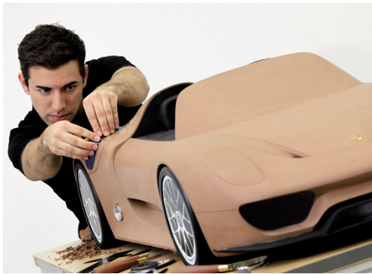
Рис. Б. 3. 34. Виконання масштабного макету Porsche 918 (а); виконання повномасштабного зіставного макету на станку з ЧПУ (б). 2010-і рр.
