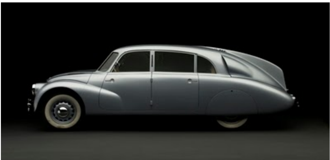
Рис. Б. 1. 22. Автомобіль «Татра тип 87», 1940 р.; обтічна форма кузова розроблена Ледвіккой
