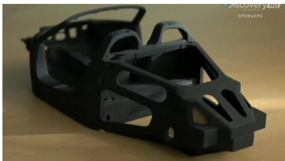
Рис. Б. 3. 34. Виконання масштабного макету Porsche 918 (а); виконання повномасштабного зіставного макету на станку з ЧПУ (б). 2010-і рр.
