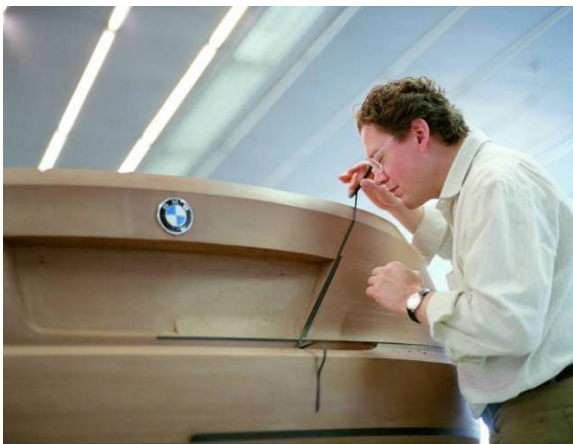
Рис. Б. 2. 59. Використання універсальних інструментів (зверху) та спеціальних (справа) при роботі з макетними матеріалами (пластилін, глина). BMW, 2000-ні рр.
