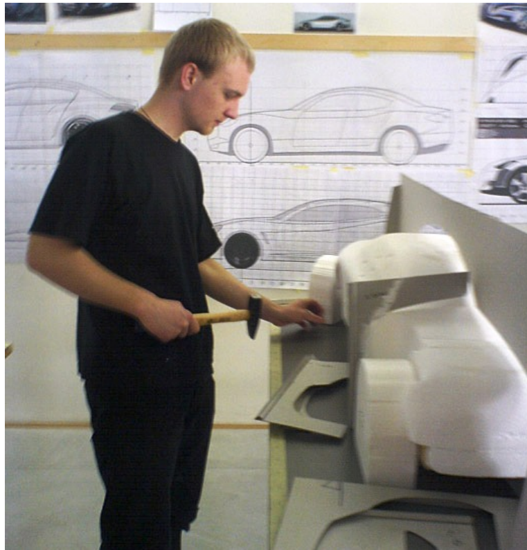
Рис. Б. 4. 7. Початок роботи над макетом – виготовлення пінопластової «болванки». Політехнічна школа дизайну (Мілан). 2010-і рр.
