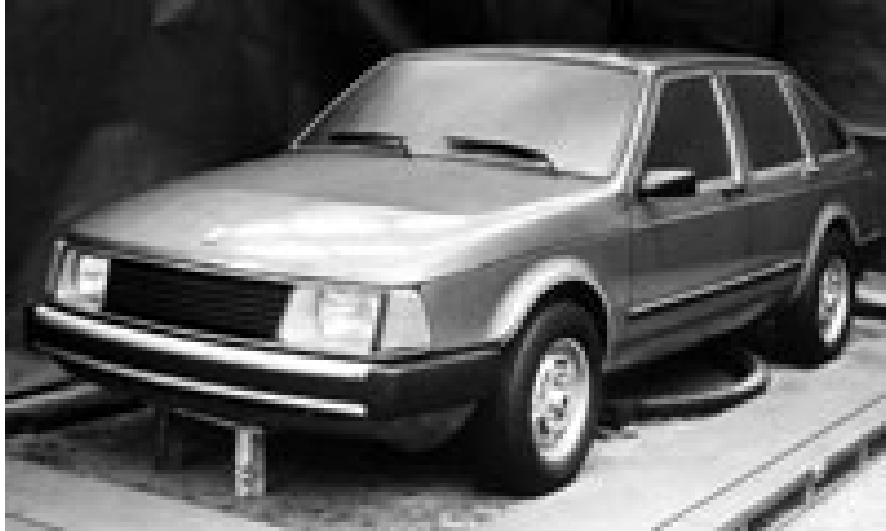
Рис. Б. 2. 18. Демонстраційний макет перспективної моделі Москвич С3. Завдяки оригінальній технології з обклеюванням пластиліну пластиковою плівкою макет виглядає як справжній кузов. 1980-ті рр.
