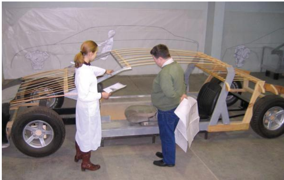
Рис. Б. 2. 22, 23. Компонувочно-габаритні макети автомобіля «Вервольф». 2000-ті рр.
