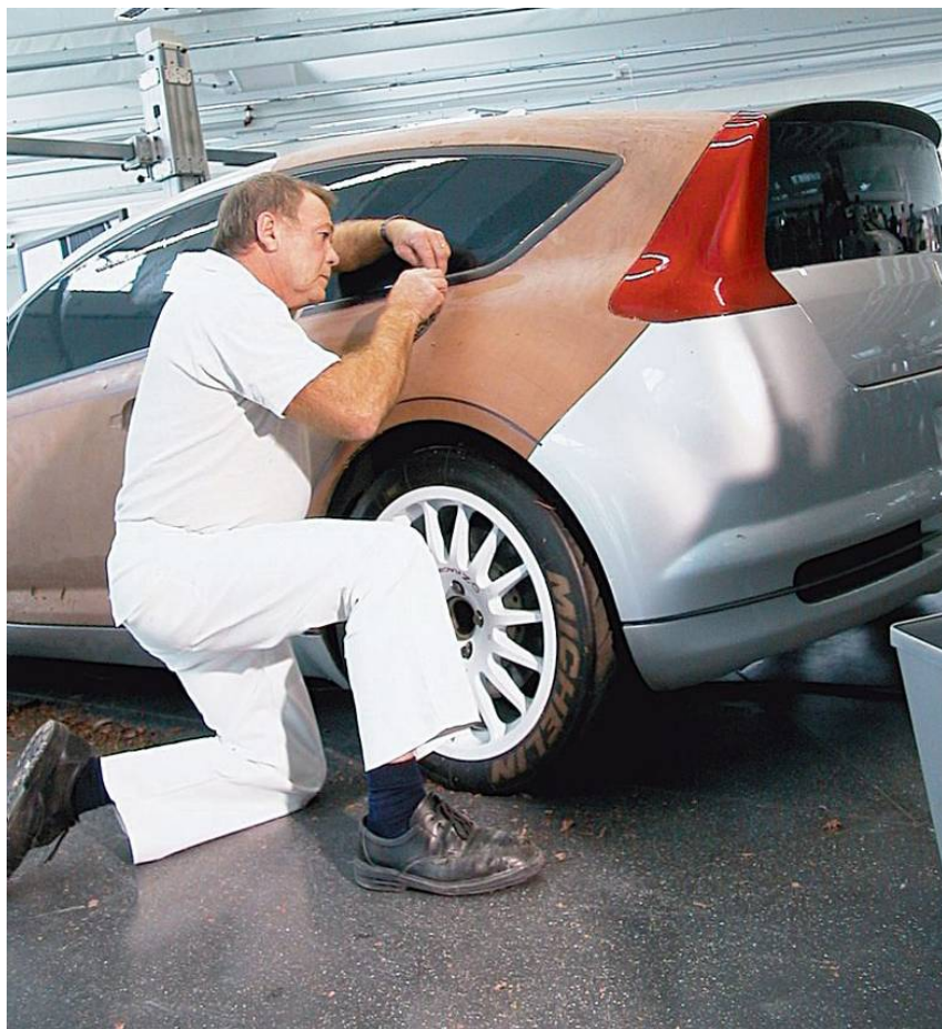
Рис. Б. 2. 30. Доопрацювання пластилінового макета Citroen C4 вручну – після фрези поверхня залишається занадто грубою. Середина 2000-х рр.
