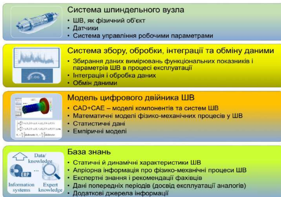
Рис. 2. Ключові компоненти для створення цифрового двійника ШВ
