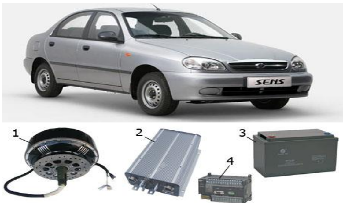
Рисунок 1 – Загальний вид автомобіля, який переобладнують, та компоненти: 1 – мотор-колесо; 2 – перетворювач; 3 – акумуляторна батарея; 4 – контролер
