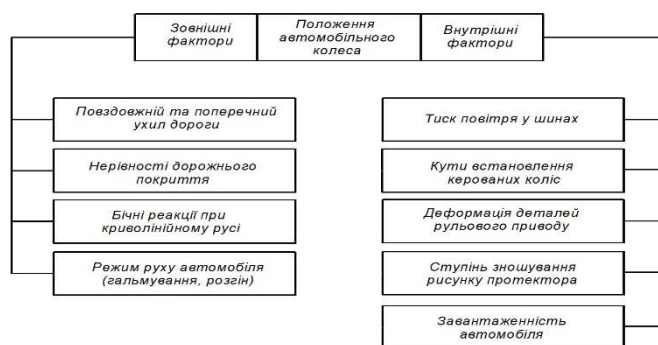
Рисунок 2 – Фактори, що впливають на динамічні кути встановлення керованих коліс під час руху транспортного засобу
