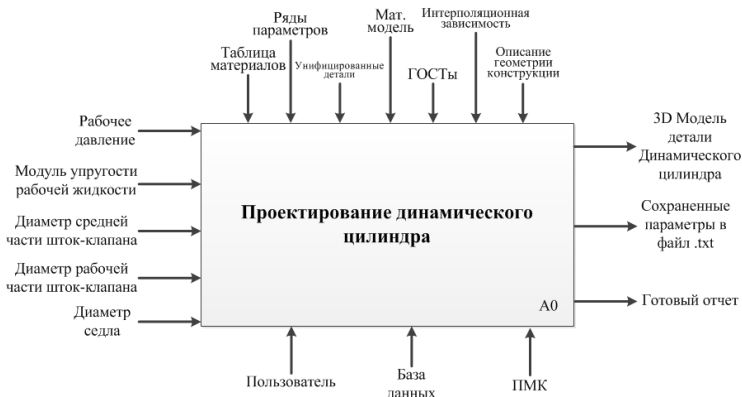
Рисунок 1 – Контекстная структурно-функциональная модель нулевого уровня процесса «Проектирование динамического цилиндра»
