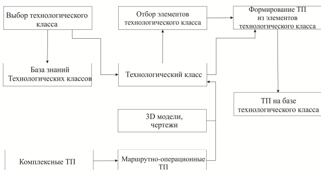
Рисунок 1 – Структурная схема проектирования ТП МЭМС акселерометров на базе комплексных объектов
