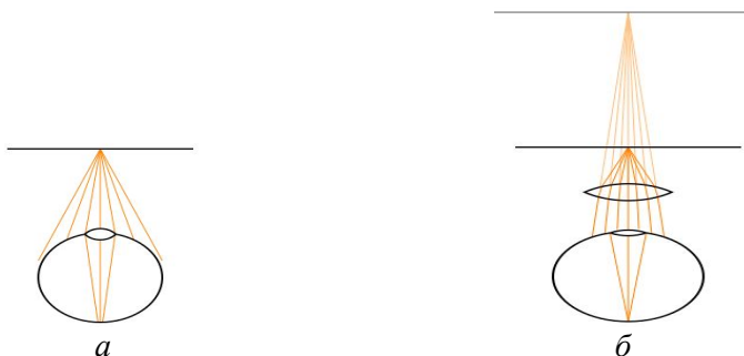
Рисунок 3 – Фокусировка человеческого глаза при использовании шлема виртуальной: а – без использования дополнительных средств адаптации; б – с использованием системы линз.
