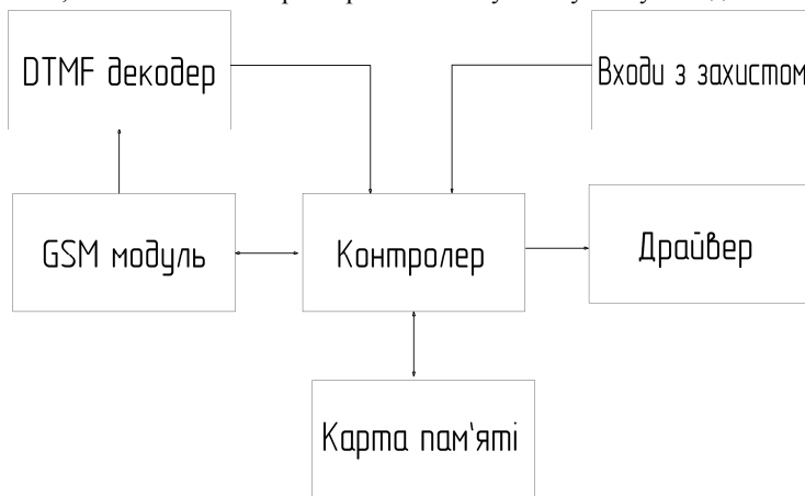
Рисунок 1 – Структурна схема GSM модуля для контролю та керування зовнішніми пристроями з голосовим меню
