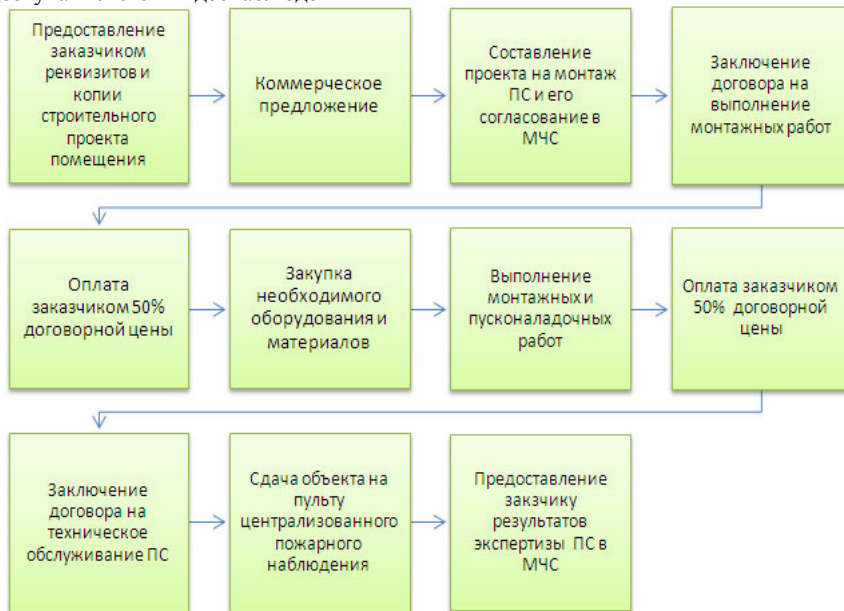
Рис. 2 – Бизнес-процесс «Монтаж пожарных сигнализаций»
