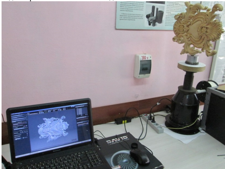
Рис.1 – Результати 3D –сканування оздоблювальної деталі
