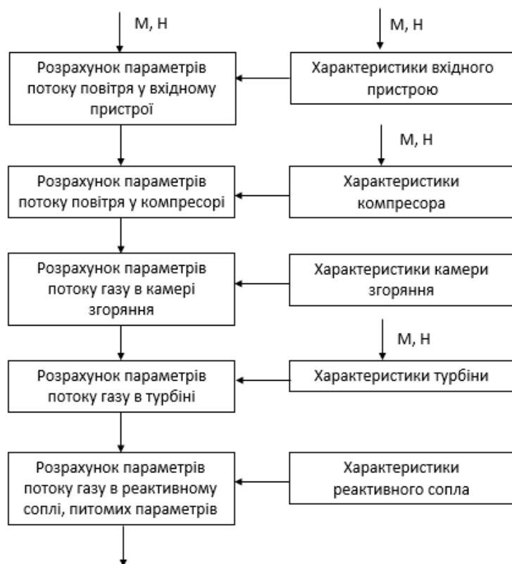
Рис.2. Схема моделювання термодинамічних параметрів ТРД
