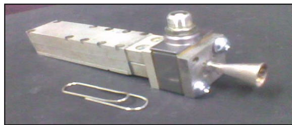
Рис. 2. Зовнішній вигляд РМ приймача прямого посилення 3мм діапазону
