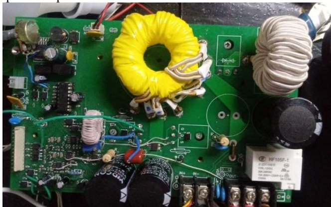
Рис.4. Силовий блок СКЗ на базі драйвера SG3525
