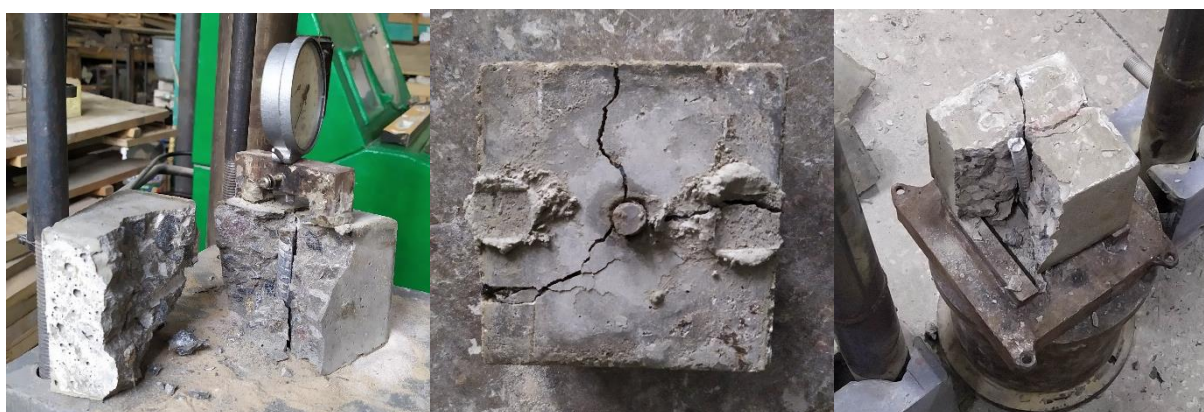
Рисунок 4. Характер руйнування зразків за дії навантажень: а) статичних методом висмикування; б) статичних методом вдавлювання; в) динамічних.
