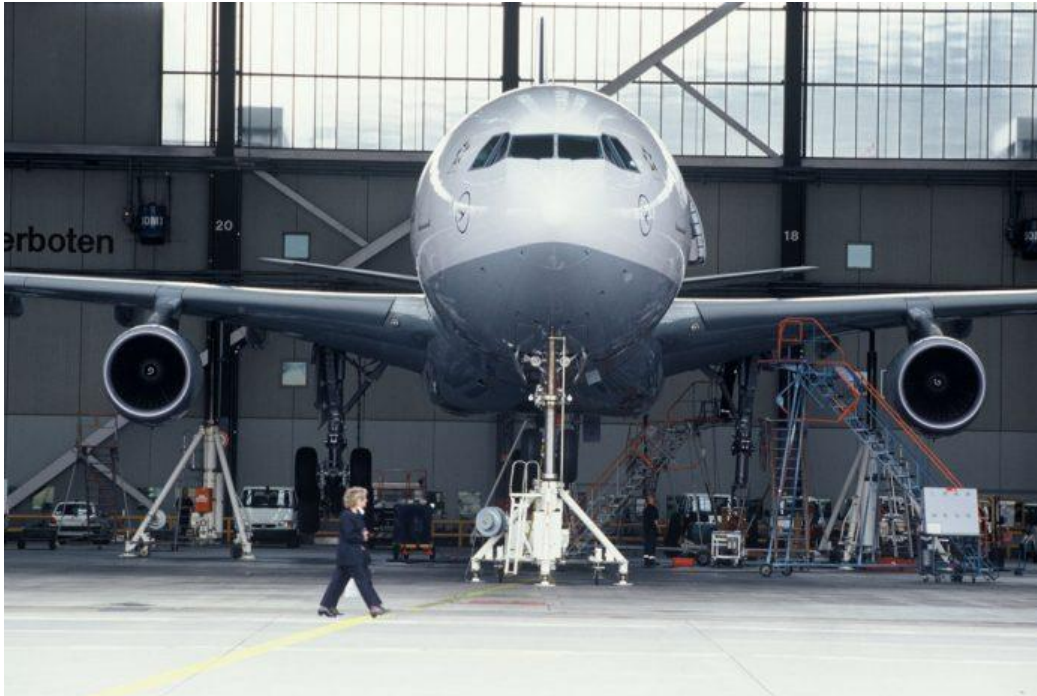
Рис. 2. Підготовка ЛА для здійснення заходів, що входять до системи ремонту за технічним станом.
