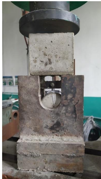
Рисунок 2. Загальний вигляд установки для випробування зразків на вдавлювання
