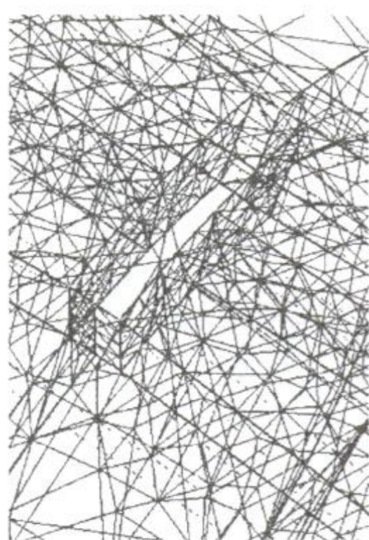
Рисунбок 5 – Дискретизация вблизи дефекта
