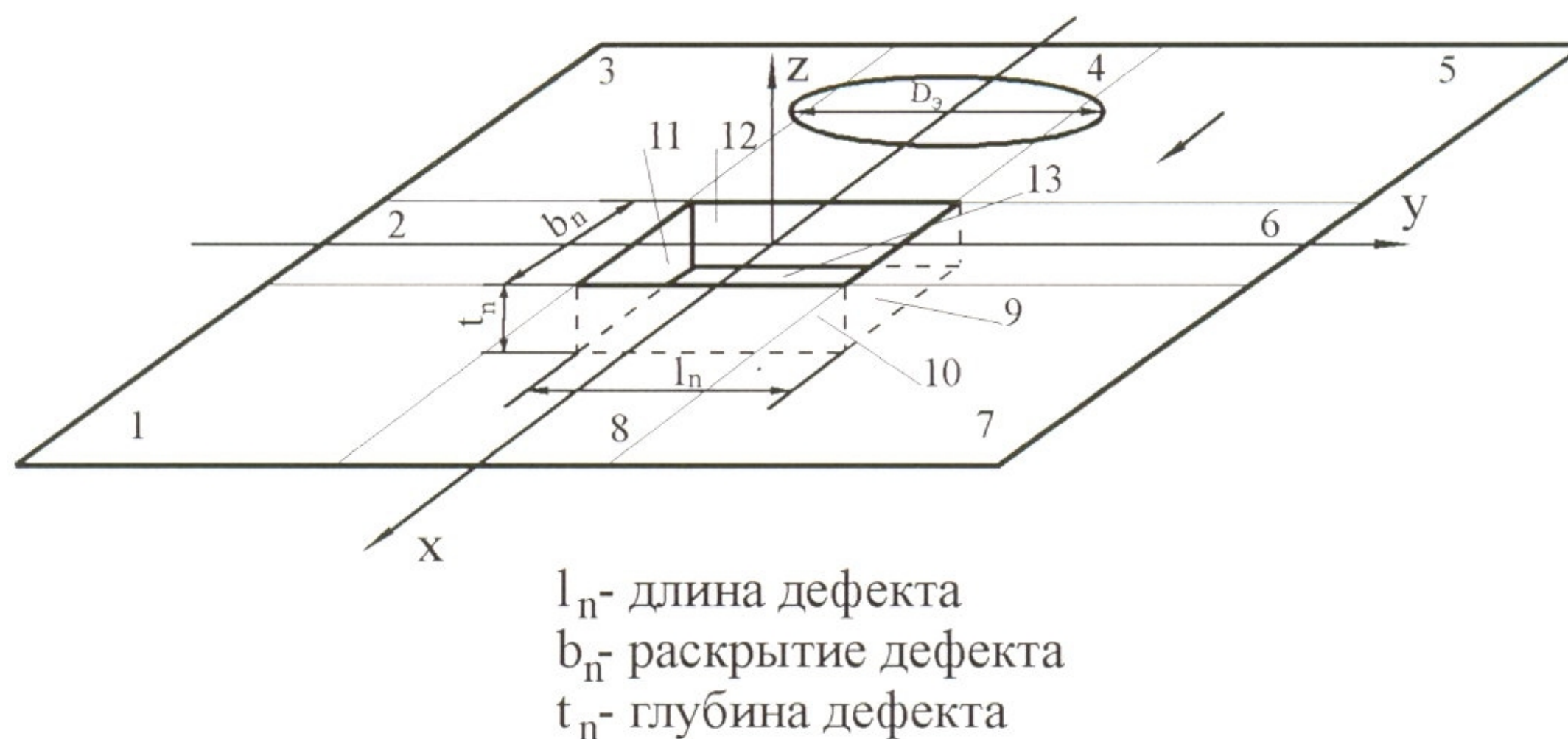
Рисунок 2. – Расчетная модель объекта с дефектом конечных размеров при контроле накладным ВТП.
