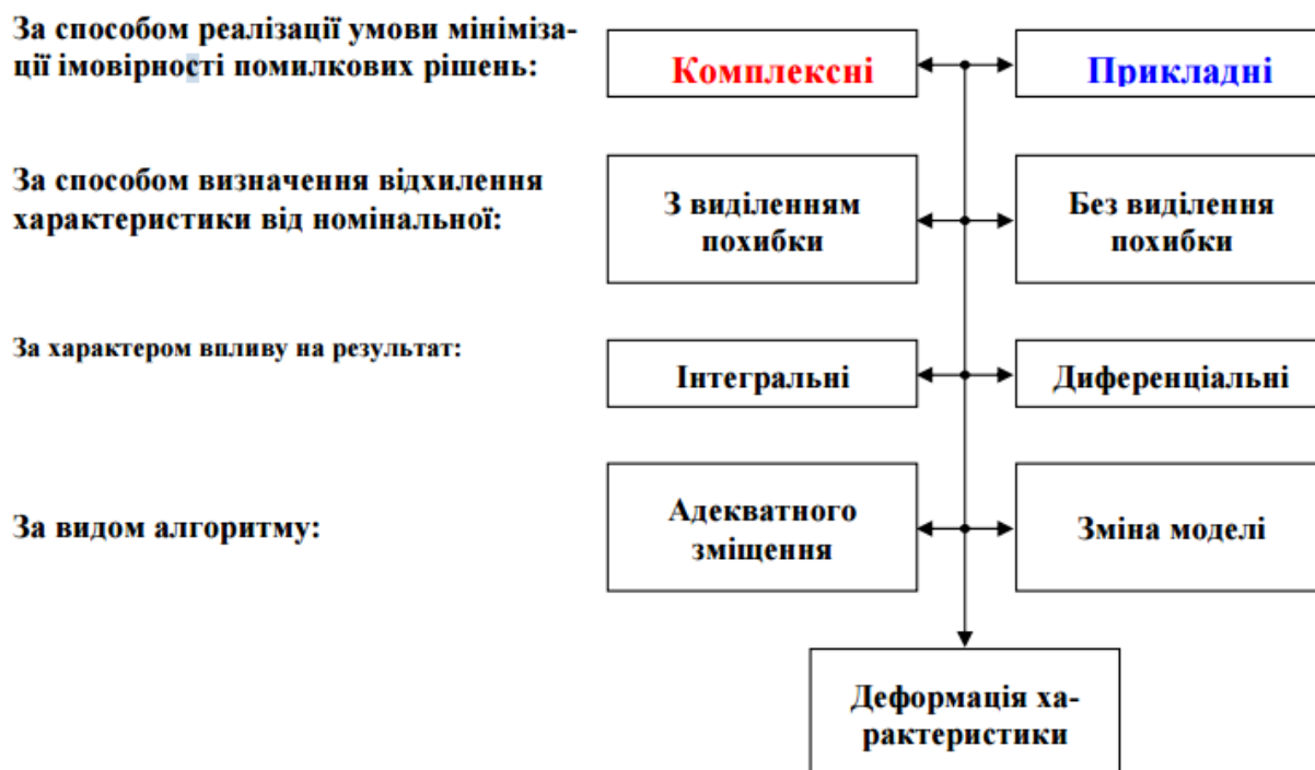
Рисунок 2.2 – Класифікація структурно-алгоритмічних методів підвищення вірогідності контролю
