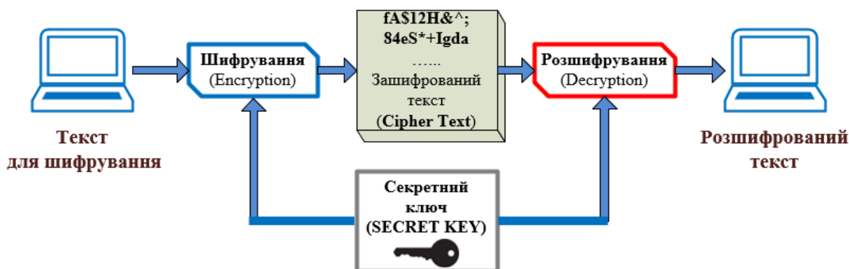
Рис. 1.2. Схема роботи симетричної криптосистеми
