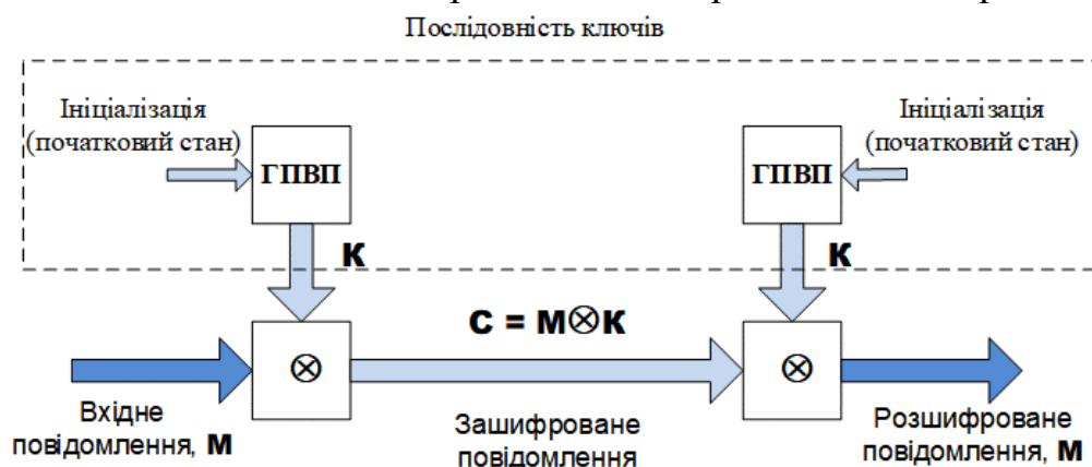
Рис.4.1. Процес шифрування повідомлення за допомогою гами
