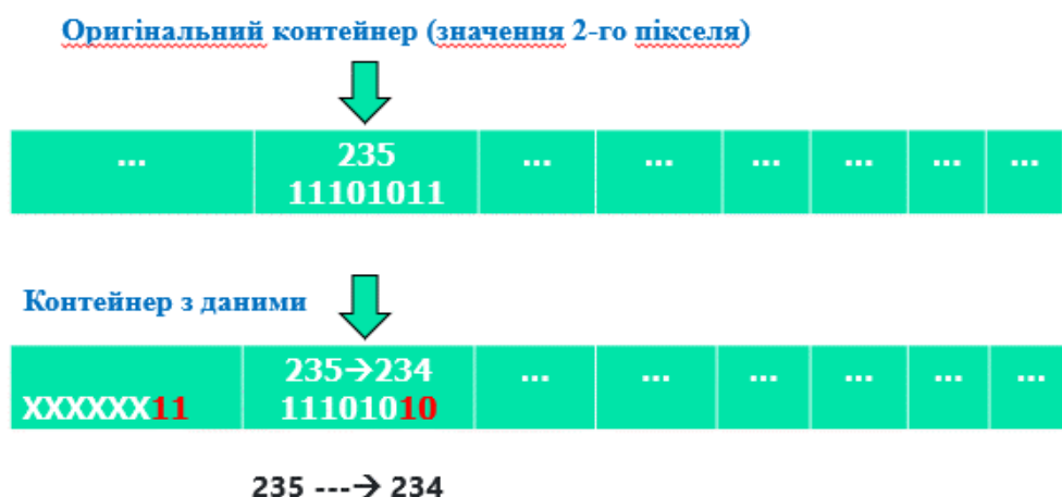
Рис.14.15. Ілюстрація застосування методу LSB на прикладі передачі секретного числа.
