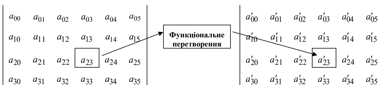
Рис. 7.5. Процедура заміни байтів в SubBytes
