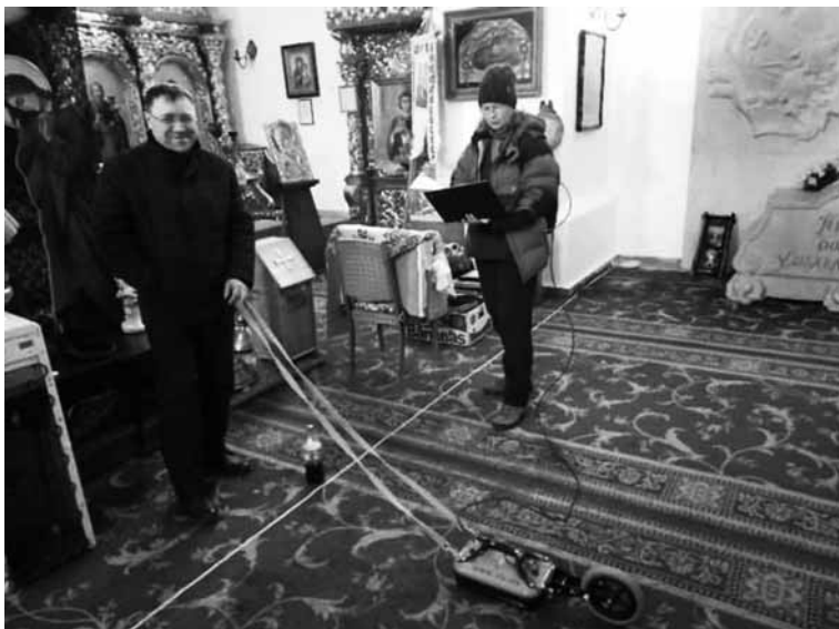
Виконання вимірювань в Іллінській церкві з георадаром VIY-3-500. 2019 р. [10]
