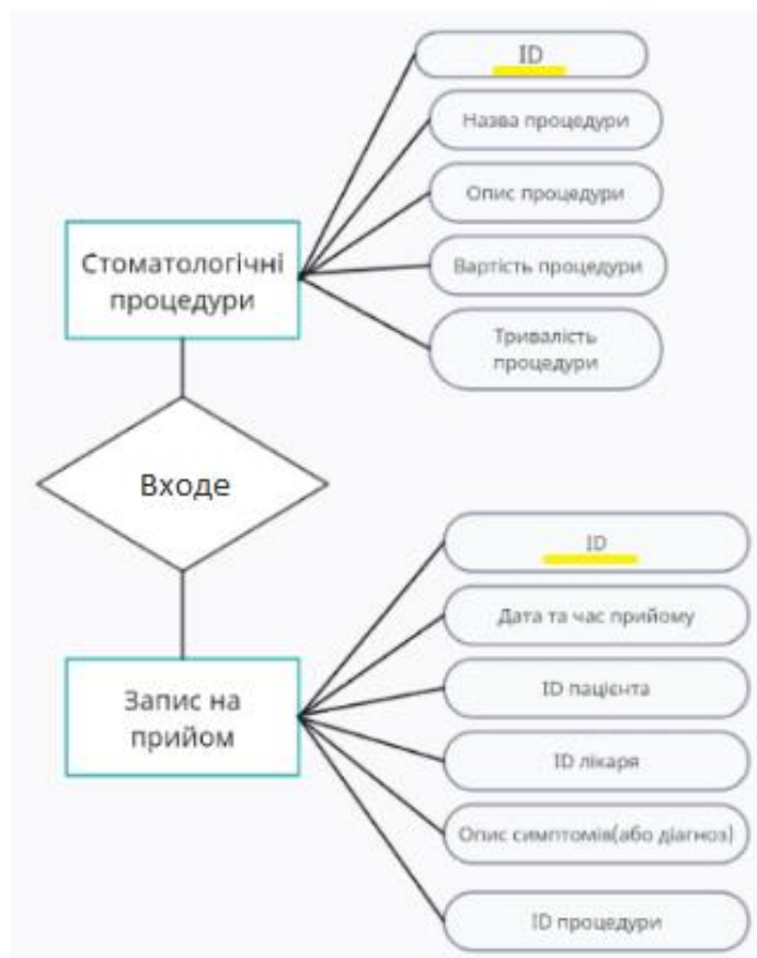
Рисунок 23 - Розширена графічна форма структурних таблиць "Стоматологічні процедури" та "Запис на прийом"
