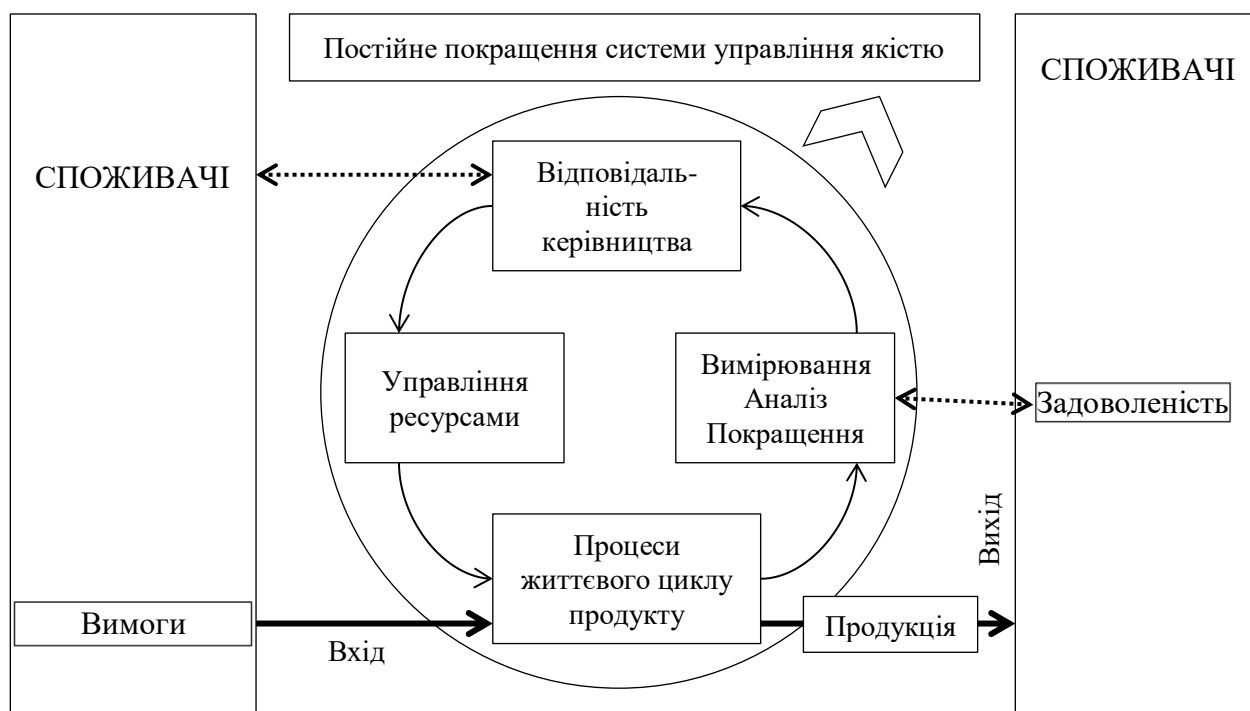
Рис. 1.11. Модель системи якості на основі процесного підходу
