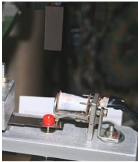
Рисунок 2.14 – Установка для визначення профілю бокової поверхні різку: а) пристрій для фіксації координат; б) схема лазерного триангуляційного вимірювача RIFTEK
