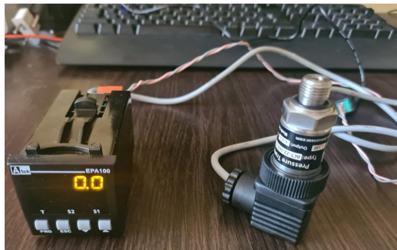
Рисунок 2.7 – Загальний вигляд п'єзорезистивного датчика тиску моделі ВСТ110 підключеного до контролера EPA100 та персонального комп'ютера
