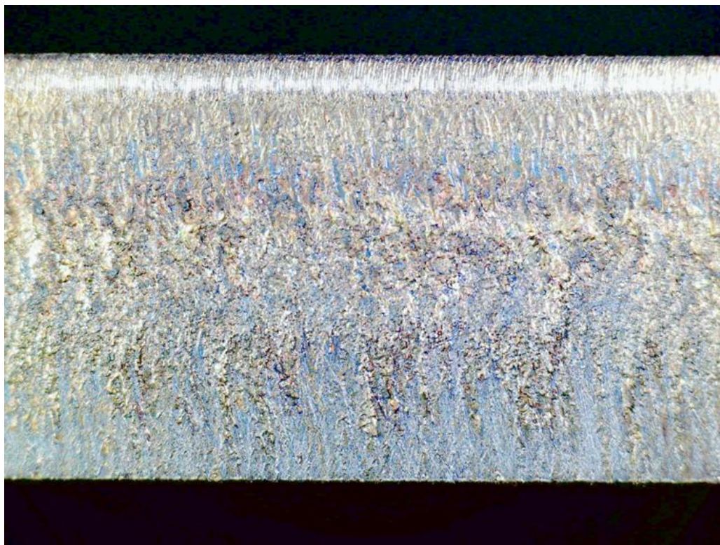
Рисунок 4.2 – Бокова поверхня листової нержавіючої сталі AISI 304 товщиною 12 мм при різанні з використанням в якості асистуючого газу повітря (режим Low – табл. 4.1)
