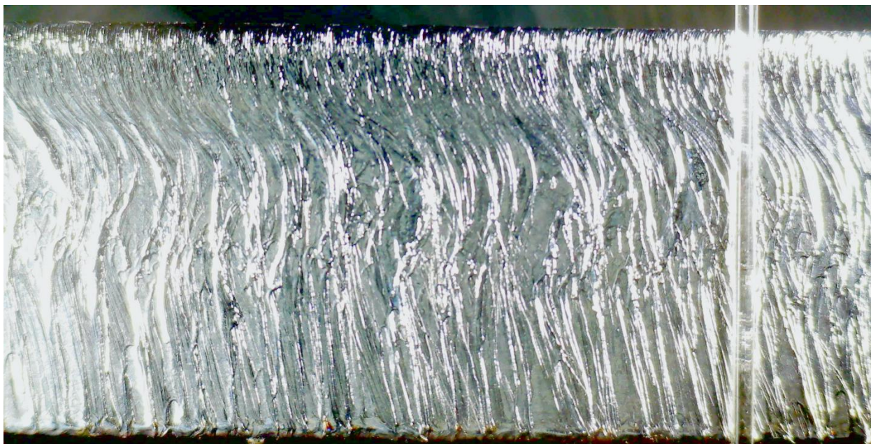
Рисунок 4.4 – Бокова поверхня листової нержавіючої сталі AISI 304 товщиною 12 мм при різанні з використанням в якості асистуючого газу азоту (режим High – табл. 4.2)
