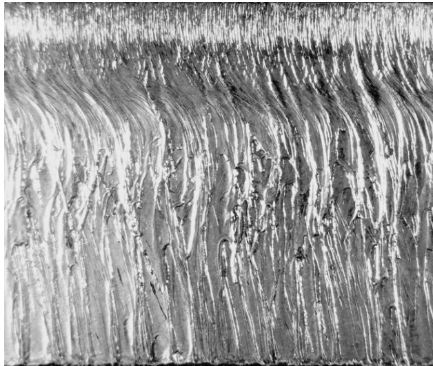
Рисунок 1.5 – Бічна поверхня різ у нержавіючій сталі товщиною 10 мм, отриманого за використання в якості асистуючого газу азоту
