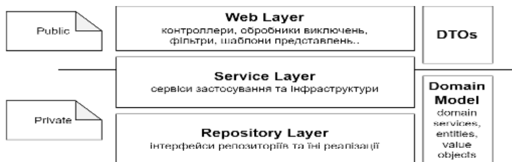
Рис. 2. Архітектура простого застосування Spring
