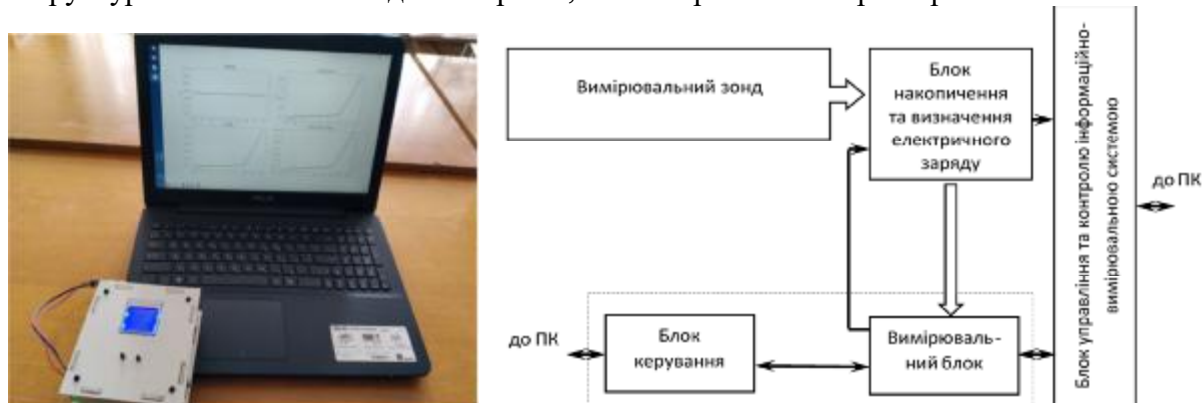
Рис. 1. Зовнішній вигляд та структурна схема інформаційно-вимірювальної системи
