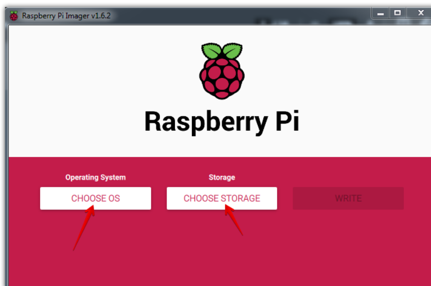
Рисунок 6.5 – Вікно програми для вибору ОС (Choose OS) та карти пам'яті (Choose Storage), яка вставлена в ПК
