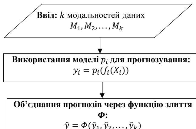
Рис. 2.2. Формальне представлення модельного поєднання мультимодальних даних
