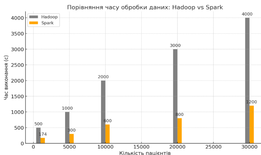
Рис. 6.21. Порівняльний аналіз продуктивності Hadoop MapReduce та Spark платформ
