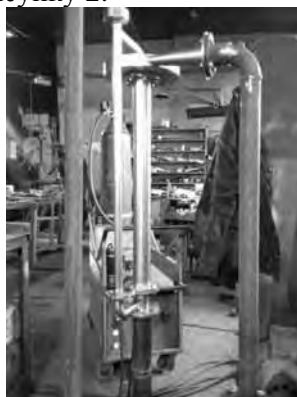
Рисунок 2 – Кавітатор для очищення стічної води
