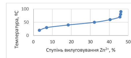
Рисунок 6 – Вплив температури Т на ступінь вилуговування йонів цинку α
