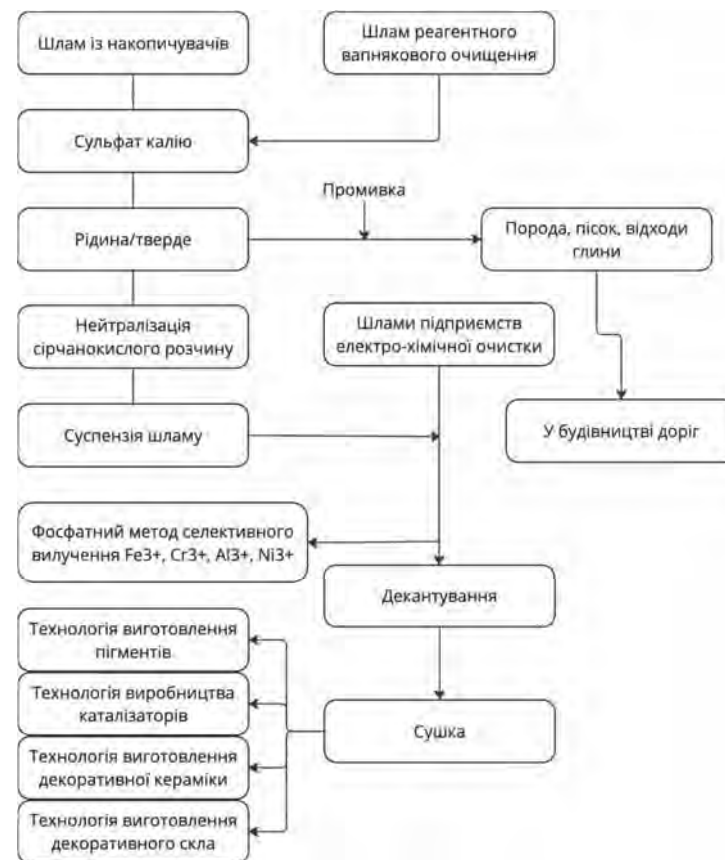
Рисунок 1 – Принципова схема технології утилізації шламів
