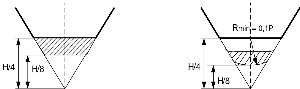
Рисунок 4.1 - Розташування границі профілю плоскорізаної та закругленої впадини зовнішньої нарізі
