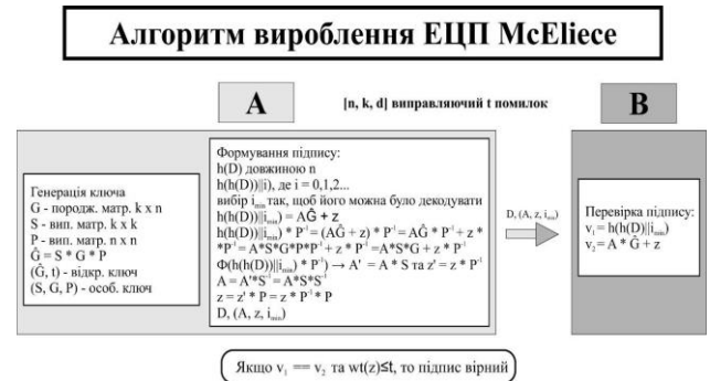
Рисунок 2 – Схема роботи алгоритму шифрування криптосистеми McEliece
