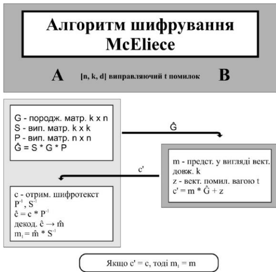
Рисунок 1 – Схема роботи алгоритму шифрування криптосистеми McEliece
