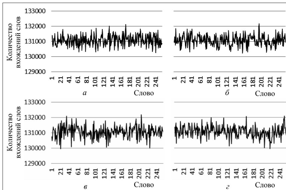
Рис. 2. График огибающей для гистограммы распределения слов последовательности: *а* — комбинационный генератор, заполнение исходных таблиц с помощью линейного конгруэнтного метода; *б* — комбинационный генератор, заполнение исходных таблиц с помощью квантового генератора случайных чисел; *в* — генератор «Вихрь Мерсенна»; *г* — случайная последовательность слов
