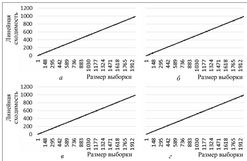
*Рис. 4.* Профиль линейной сложности: *а* — комбинационный генератор, заполнение исходных таблиц с помощью линейного конгруэнтного метода; *б* — комбинационный генератор, заполнение исходных таблиц с помощью квантового генератора случайных чисел; *в* — генератор «Вихрь Мерсенна»; *г* — случайная последовательность слов
