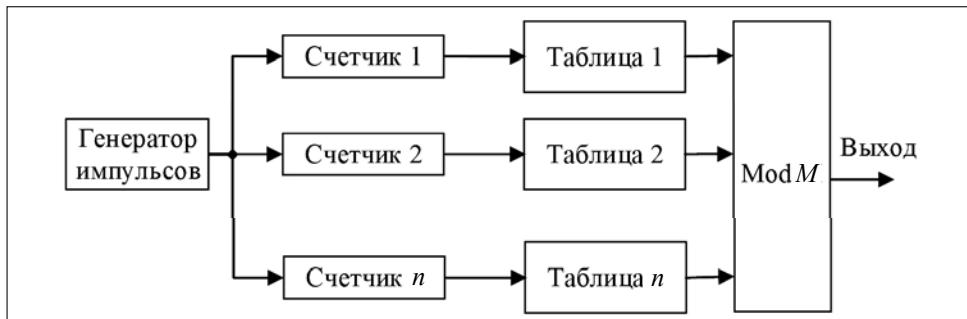
Рис. 1. Структурная схема комбинационного генератора
