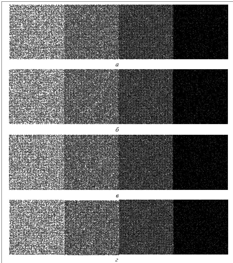
Рис. 3. Распределение слов на плоскости: *а* — комбинационный генератор, заполнение исходных таблиц с помощью линейного конгруэнтного метода; *б* — комбинационный генератор, заполнение исходных таблиц с помощью квантового генератора случайных чисел; *в* — генератор «Вихрь Мерсенна»; *г* — случайная последовательность слов
