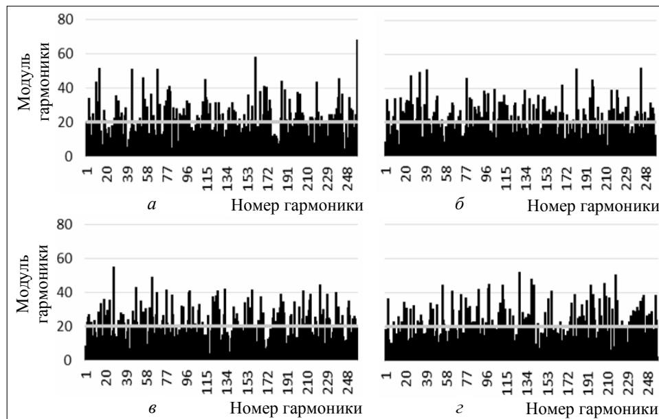
*Рис. 5.* Графический спектральный тест: *а* — комбинационный генератор, заполнение исходных таблиц с помощью линейного конгруэнтного метода; *б* — комбинационный генератор, заполнение исходных таблиц с помощью квантового генератора случайных чисел; *в* — генератор «Вихрь Мерсенна»; *г* — случайная последовательность слов
