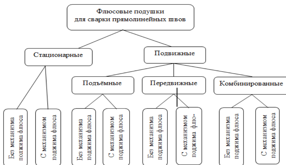
Рисунок 1 – Общая классификация флюсовых подушек для автоматической сварки прямолинейных швов
