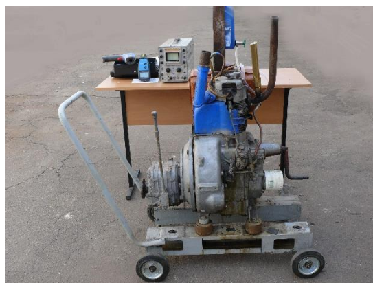
Рисунок 3 – Одноцилиндровый четырехтактный дизельный двигатель для проведения исследований
