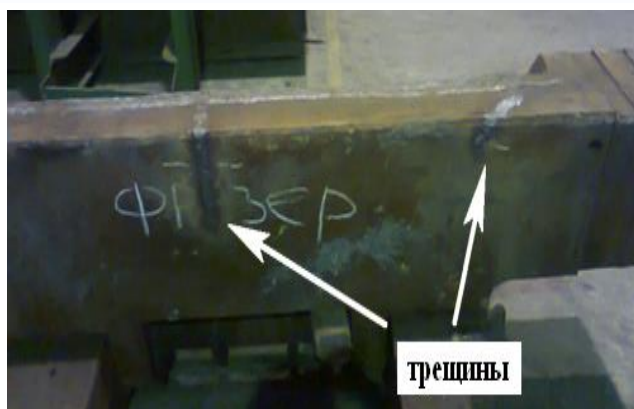
Рисунок 1 – Головка затравки укороченної конструкції: а – розподілення напружень в трьохмерній моделі головки; б – фото дефектів з обротної сторони робочої головки затравки
