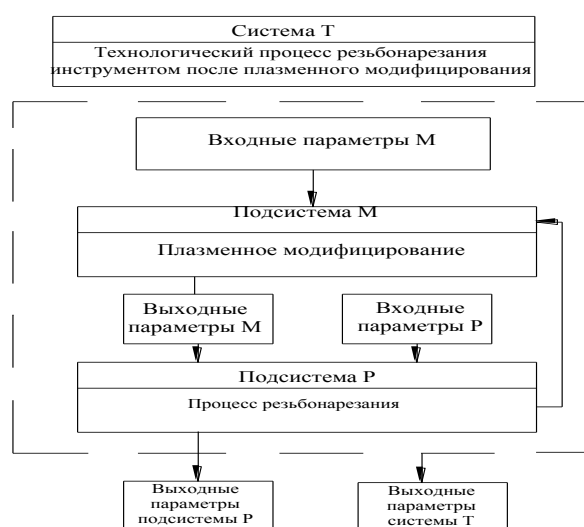
Рисунок 3 – Структурная схема технологической системы «Технологический процесс резбонарезания инструментом, прошедшим плазменное модифицирование»
