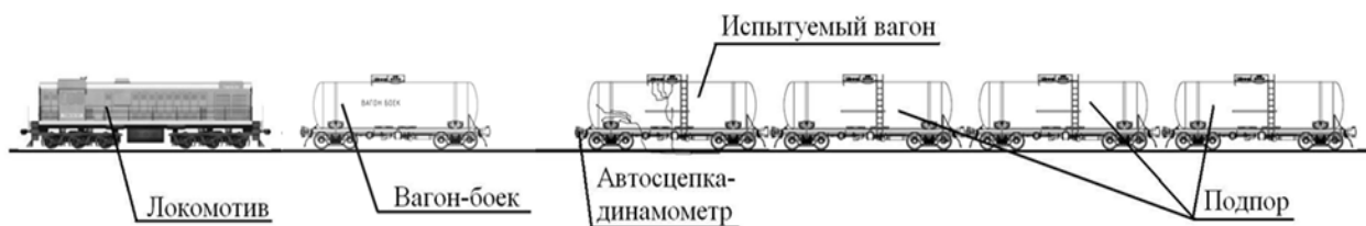
Рисунок 1 – Схема расположения вагонов при испытаниях
