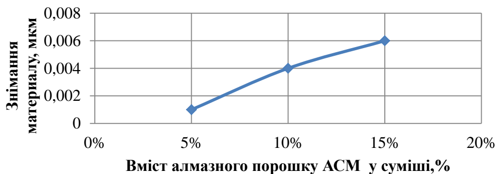
Рисунок 4 – Залежність радіусу скруглення кромки зразка від вмісту порошку алмазу АСМ 20/14 в суміші
