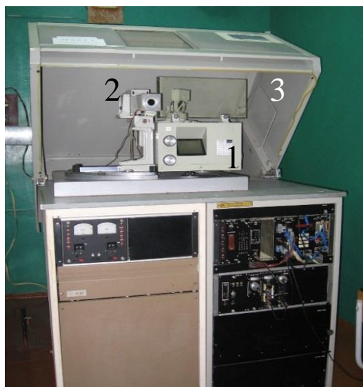
Рисунок 2 – Загальний вигляд дифрактометра рентгенівського ДРОН – 3М: 1 – джерело рентгенівського випромінювання ІРИС – 0; 2 – комплекс керуючий дифрактометричний КУД – 1; 3 – захист
