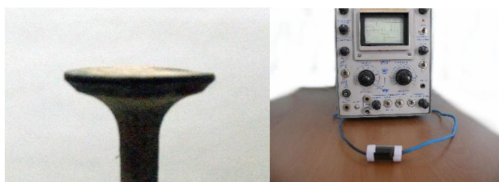
Рисунок 1 – Отложения на поверхности тарелки клапана, фрагмент замера проводимости сажи
