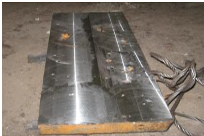
Рисунок 2 – Внутренние дефекты в отливке из стали 35Л на глубине 15 мм
