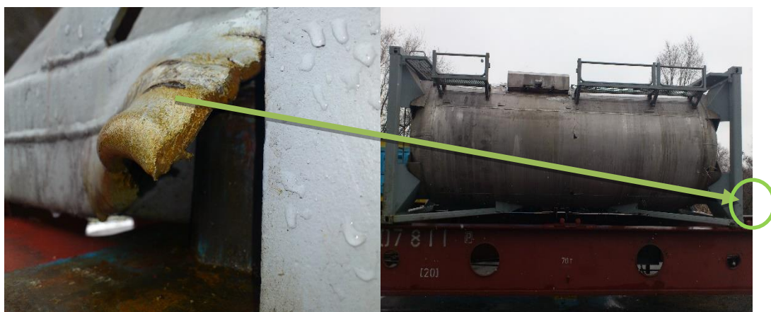
Рисунок 2 – Зона потери прочности угловых фитингов контейнера-цистерны
